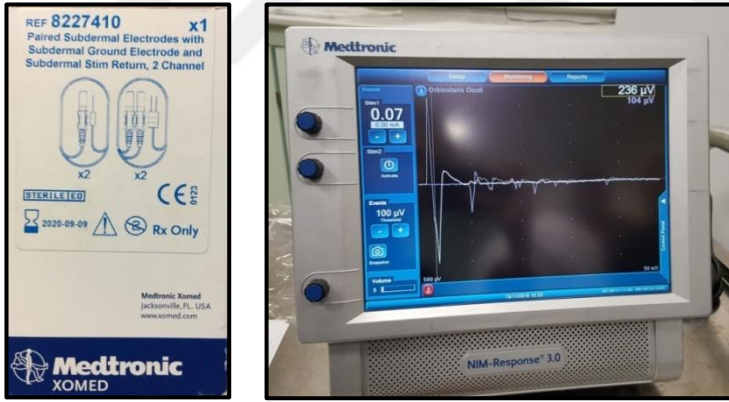
Resim 10: NIM çiftli subdermal elektrot ve Medtronic NIM-Response 3.0 Monitor.
