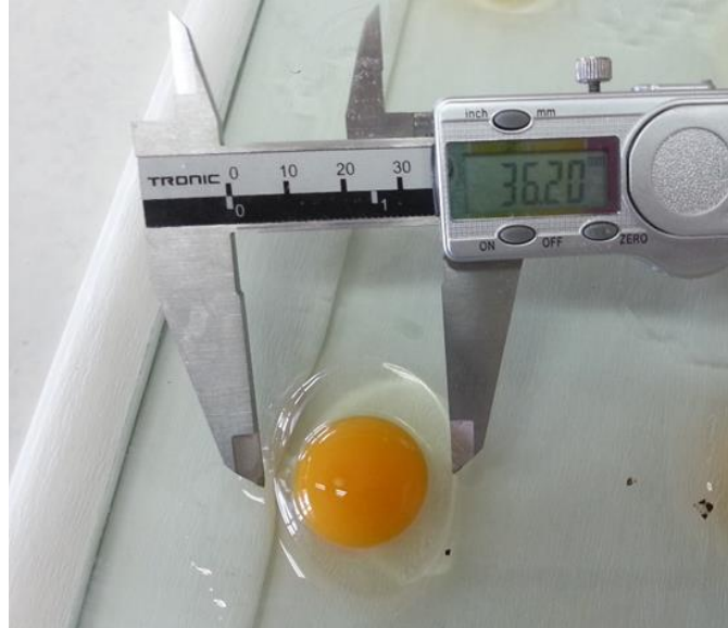
Şekil 9. Dijital kumpas kullanılarak yumurta ak ve sarı ölçümlerinin yapılması.
