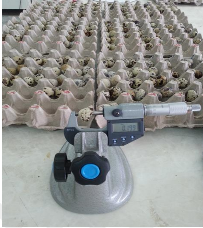
Şekil 8. Dijital mikrometre ile yumurta kabuk kalınlığının ölçümü.
