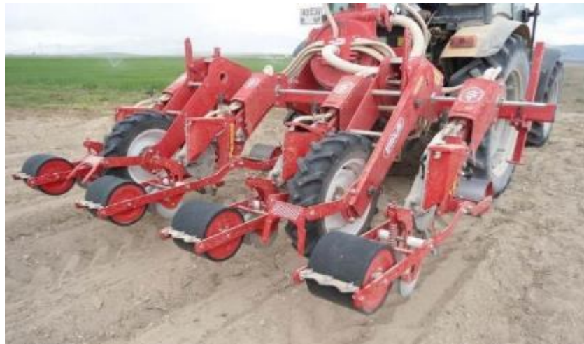
Şekil 3.2. Araştırmada kullanılan vakumlu tip pnömatik hassas sebze ekim makinesi
