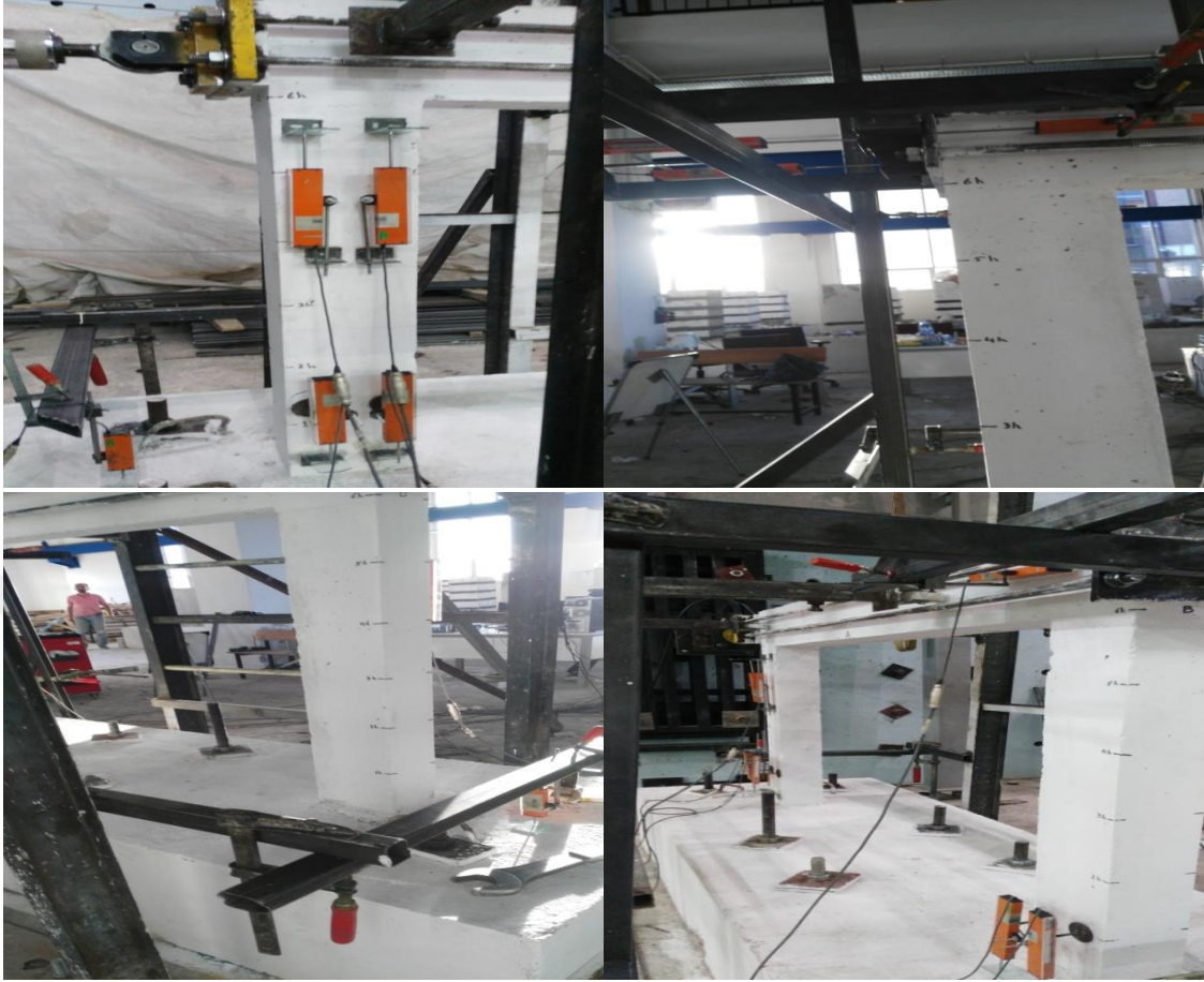
Şekil 3.32. LVDT lerle numuneden veri toplanması
