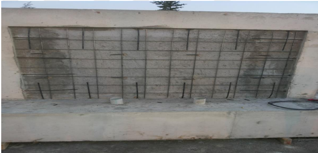
Şekil 3.25. 3 no’lu numune ankraj detayları
