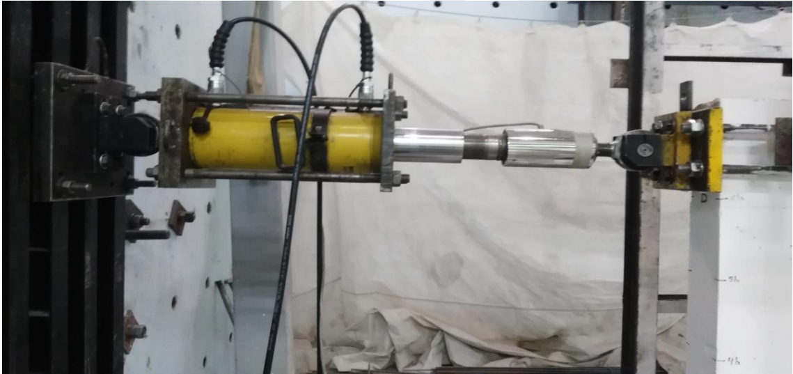
Şekil 3.27. Yükleme düzeneği, krika ve yük hücresi
