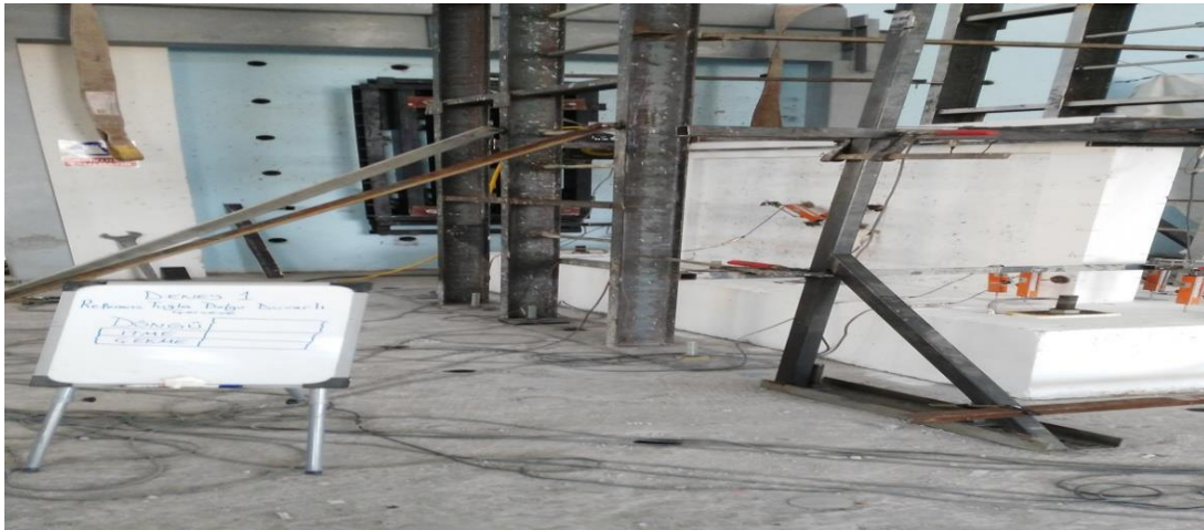
Şekil 3.33. Dolgu duvarlı numunesine yatay yükleme yapılması
