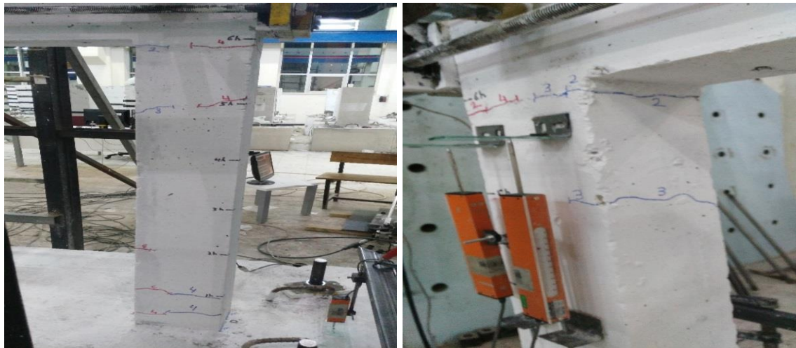
Şekil 4.2. 4. döngü sonunda çatlak durumu
