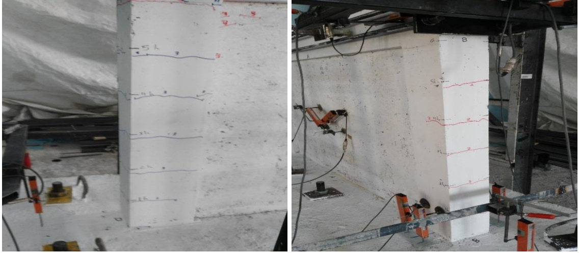
Şekil 4.8. Dolgu duvarlı referans çerçevede 2 ve 3. döngüde oluşan çatlaklar
