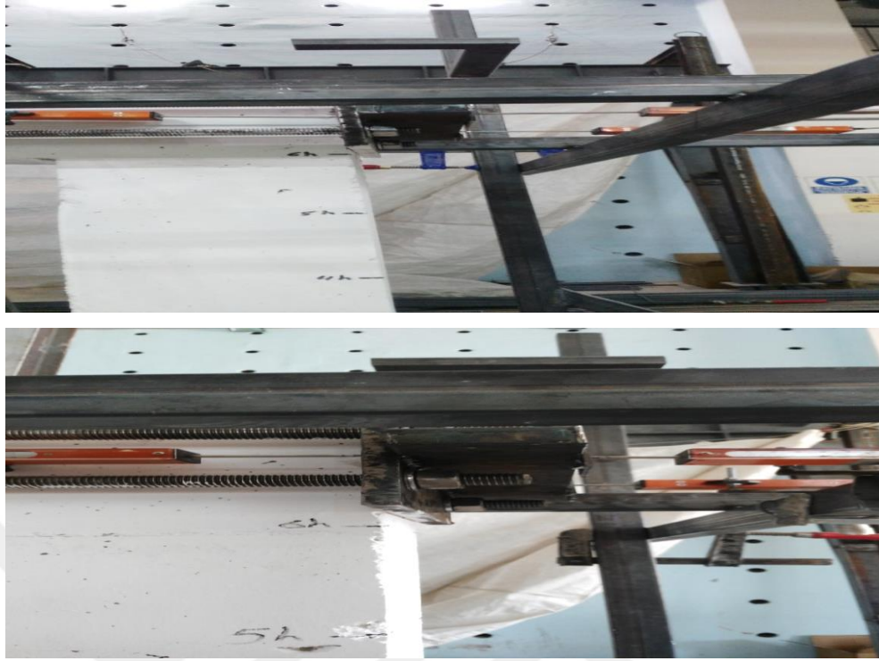
Şekil 3.34 : LVDT lerle numuneden veri toplanması
