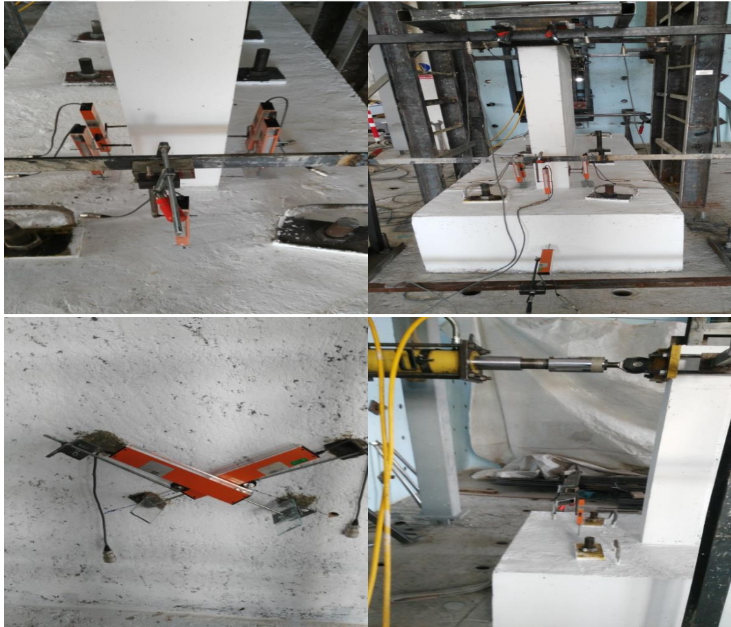
Şekil 3.34. LVDT lerle numuneden veri toplanması
