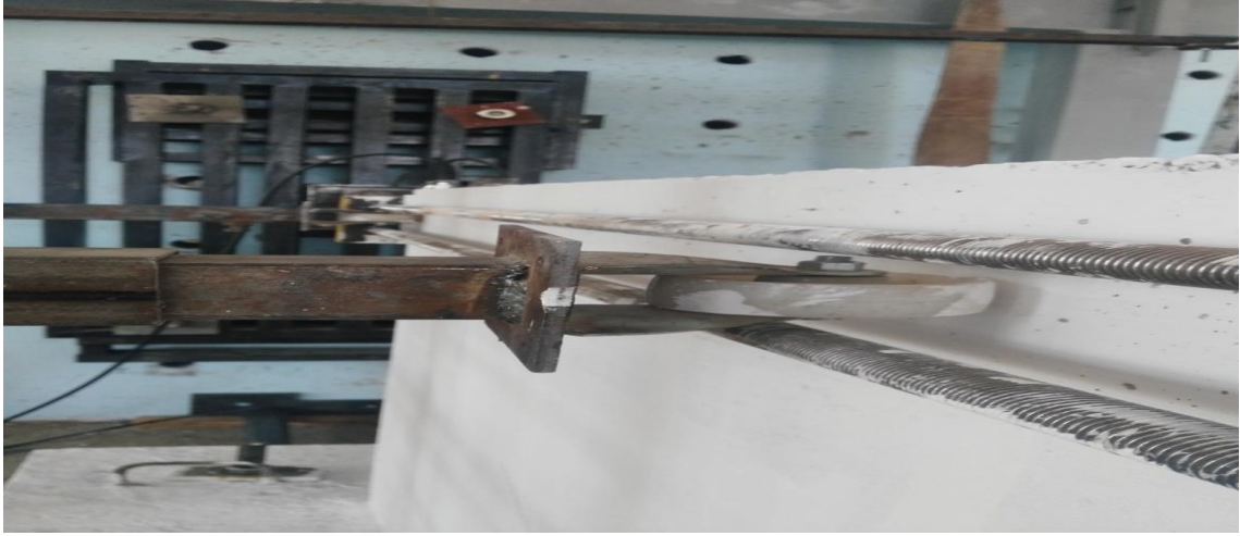
Şekil 3.26. Düzlem dışı hareketi engellemek için yapılan kayıcı mesnetler
