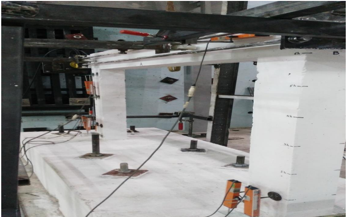
Şekil 3.31. Boş çerçeve numunesine yatay yükleme yapılması
