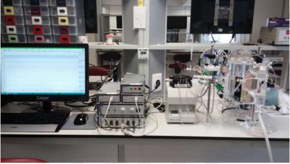
Şekil 3.1: Langendorff izole kalp sistemi.
