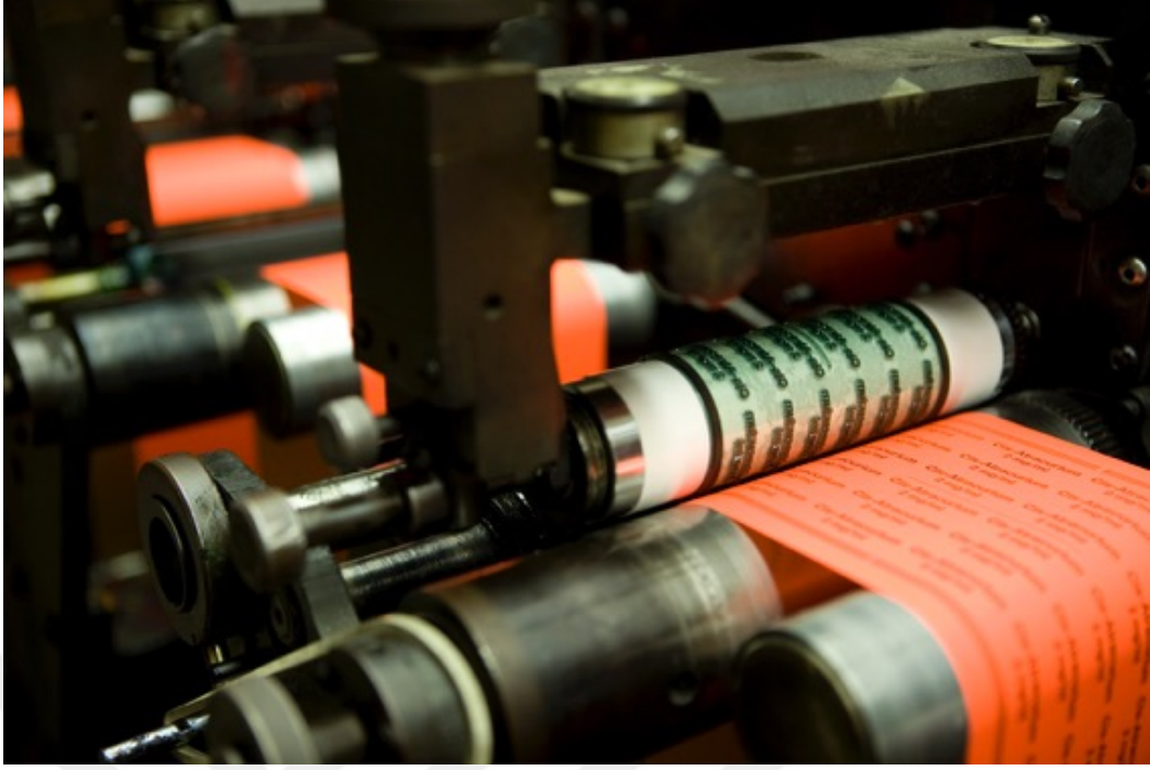
Görsel 1.19. Flekso baskı tekniğinde polimer ya da kauçuk, silindir kalıplar kullanılmaktadır.
