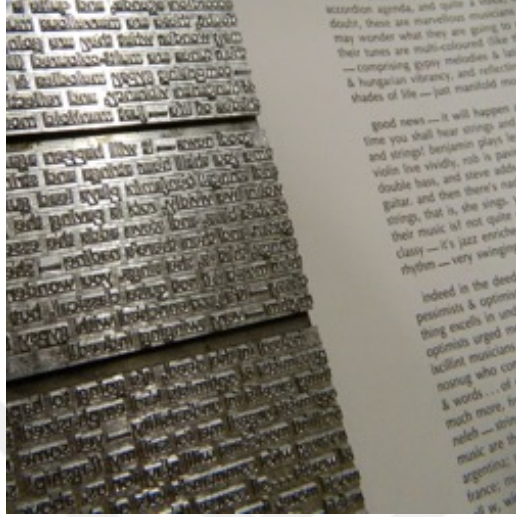
Görsel 1.17. Linotipi dizgi, harfleri satır satır dökmetedir.
