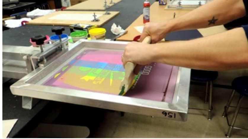
Görsel 1.26. Serigrafi yönteminde ipeğin üzerinde kapatıcı medyumun olmadığı yerler boyayı altında bulunan kağıda geçirmektedir.
