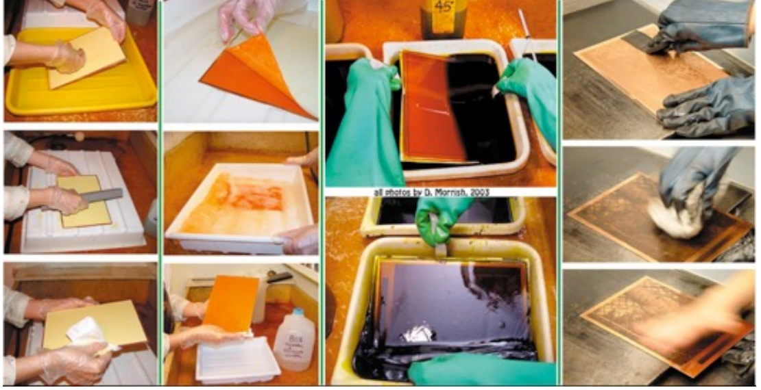
Görsel 1.33. Fotogravür tekniği fotoğrafın metal plakaya pozlandıktan sonra gravür yöntemleri ile indirgenmesi ile basıma hazır hale getirilir.
