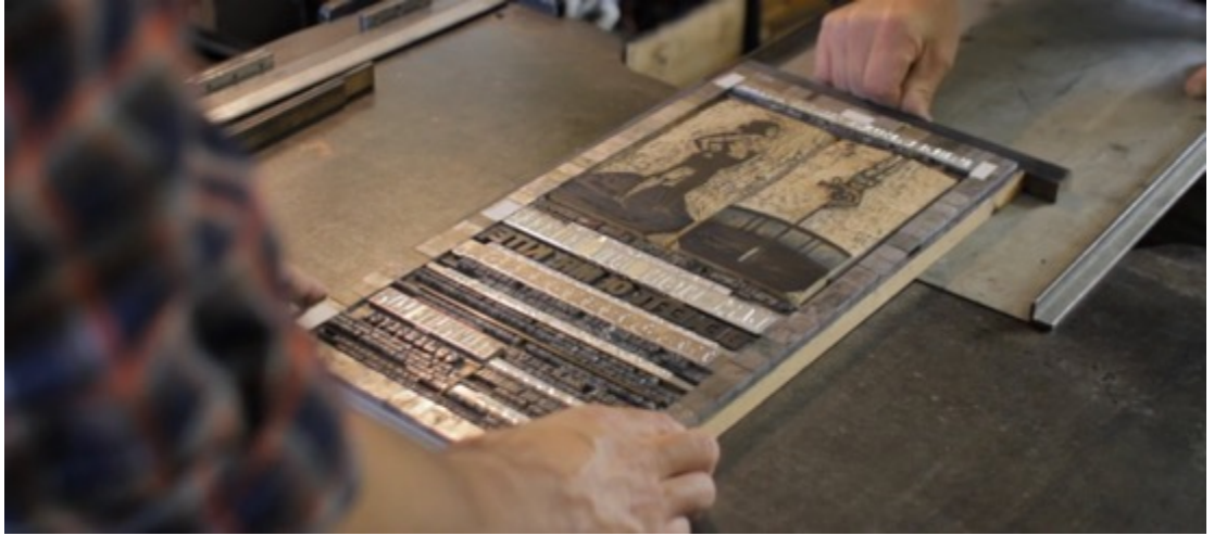
Görsel 2.12. Tipobaskıda poster için hazırlanan kalıpta yazı ile görsel ayrı alanlarda kullanılabilmektedir ve tipografi kalıbın düz çizgileri doğrultusunda dizilebilmektedir. Nick Esdaile ve Joe Fellows: John Lennon Poster
