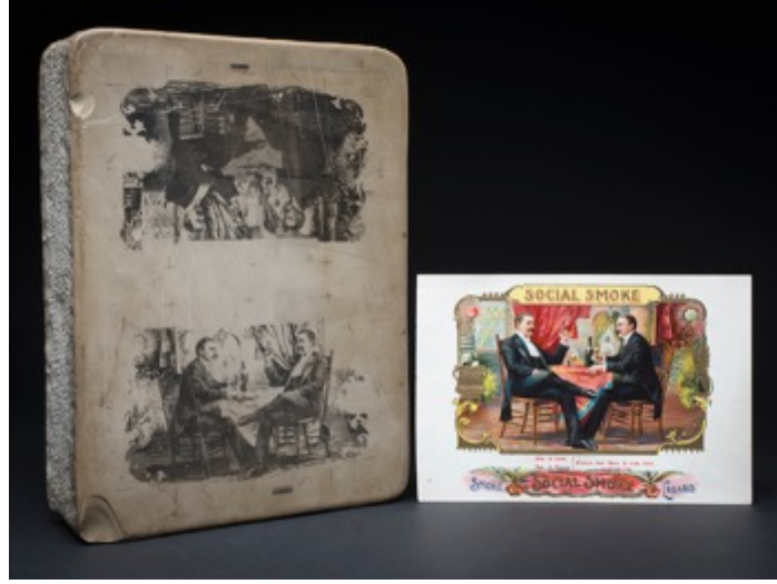
Görsel 1.23. Renkli litografide her bir renk için yeni yeni bir kalıp kullanılmaktadır.
