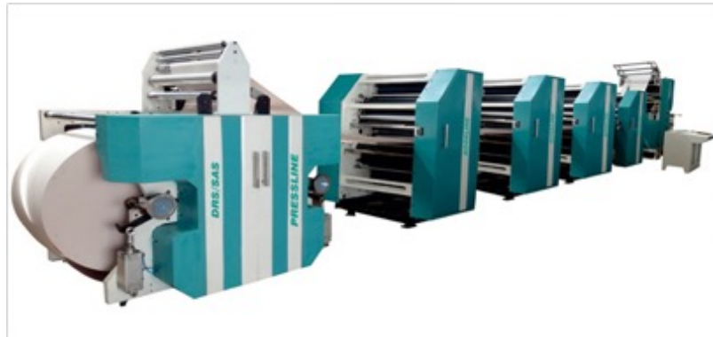
Görsel 1.24. Web ofset baskıda bobin kağıt kullanılması çok yüksek hızlarda baskı yapılabilmesini sağlamıştır.
