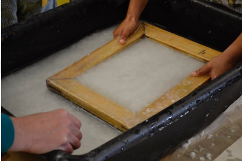
Görsel 1.6. Kağıt yapımında, ahşap parçalardan elde edilen posa eleklerin üzerine yayılır.
