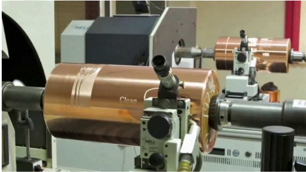
Görsel 1.21. Tifdruk baskıda kullanılan kalıplar genellikle bakırdan ve silindir şeklinde yapılmaktadır. Kaynak: https://i.ytimg.com/vi/WTm5PYlJ99E/maxresdefault.jpg (Erişim Tarihi: 08.08.2017)
