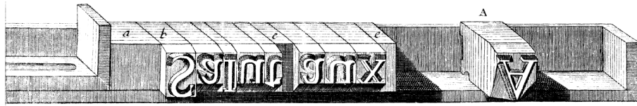
Görsel 2.71. Metal dizgi harf yatağında kelimeleri oluşturmak için metal harflerin tek tek yan yana dizildiği görülmektedir.
