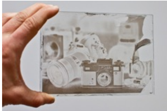
Görsel 1.31. Kolodyum tekniğinde negatif oluşturmak için metal plaka yerine cam kullanılmaktadır.
