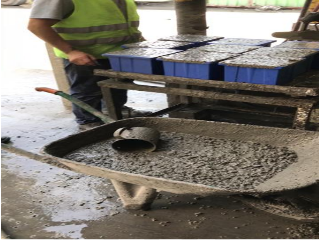
Şekil 3.3: Sarsma tablasında beton numuneleri.
