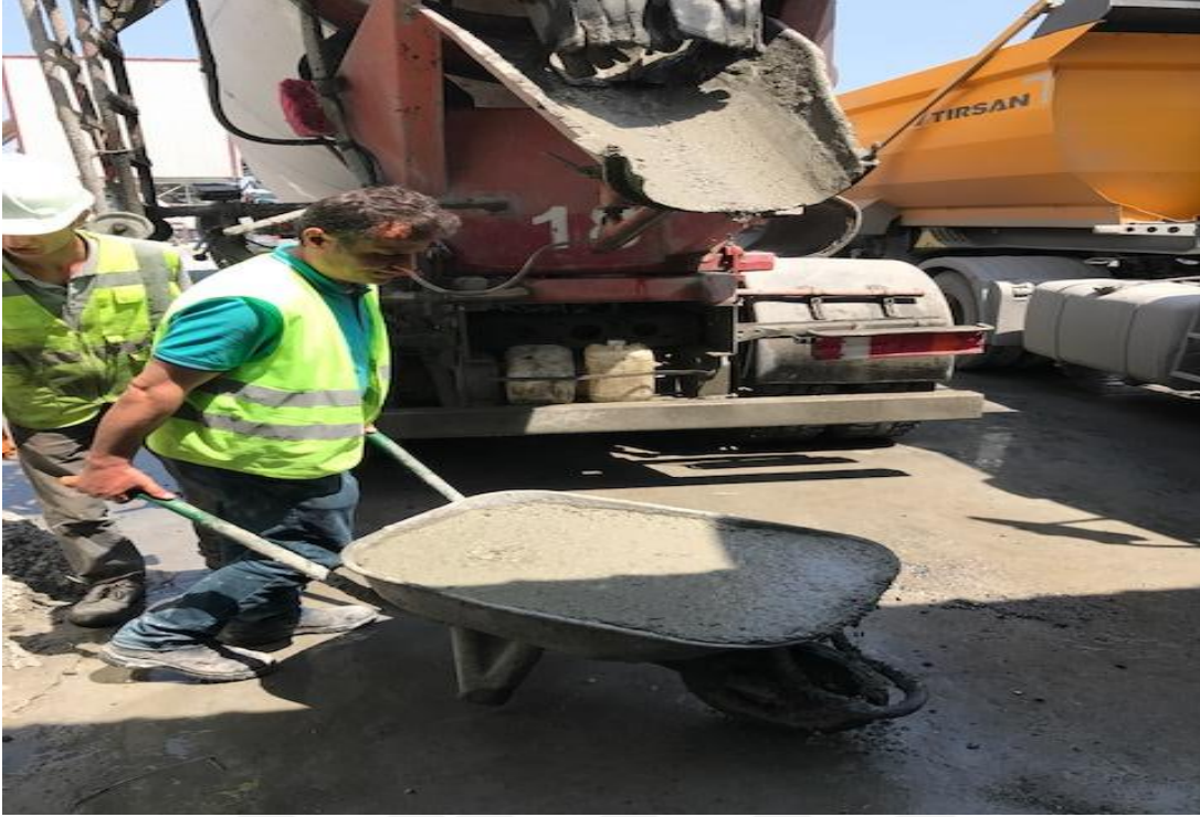
Şekil 3.2: Beton mikserinden alınan deney grubu 1 betonu.
