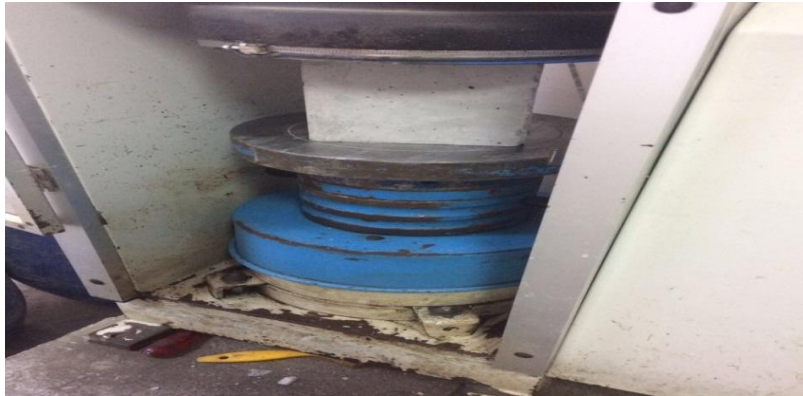
řekil 3.6: Kuruyan numunelerin beton test cihazında kırılması.
