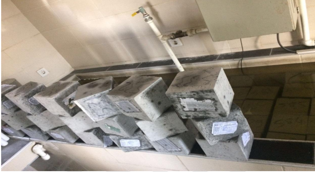
řekil 3.5: Křr havuzunda bekleyen numunelerin kırıma hazır hale getirilmesi.
