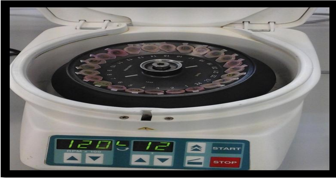
Şekil 3.6. Örneklerin iki faza ayrılmasını sağlamak amaçlı santrifüj aşaması
