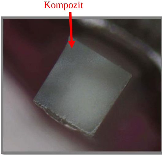
Şekil 4-6: Kompozit reçine yüzeyinde gözlenen koheziv kopma
