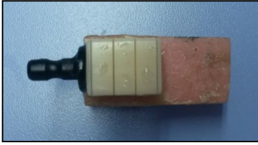
Şekil 3-21: Nanoseramik reçine blok materyalinin yatay olarak kesilmesi
