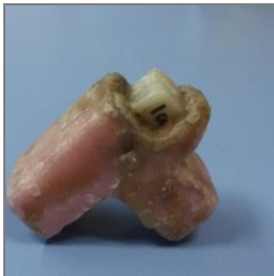
Şekil 3-35:Numunenin sirkolan mum yardımıyla akrilik bloğa sabitlenmesi
