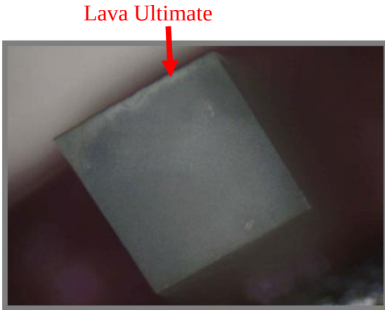
Şekil 4-7: Lava Ultimate blok yüzeyinde gözlenen koheziv kopma
