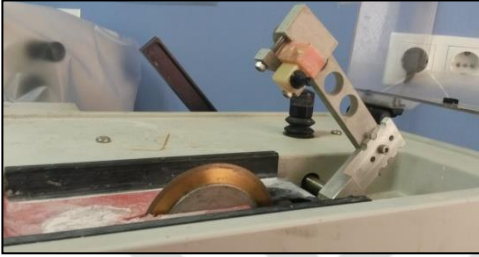
Şekil 3-20: Nanoseramik bloğun akrilik bloğa sabitlenmesi ve kesilmesi
