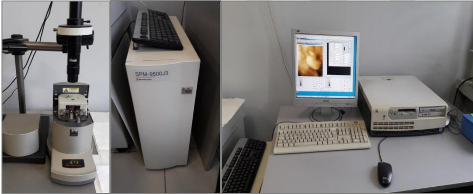
Şekil 3-40: Şekil 3-41: Şekil 3-42: AFM cihazına numunelerin yerleştirilmesi ve ekrandaki görünümü
