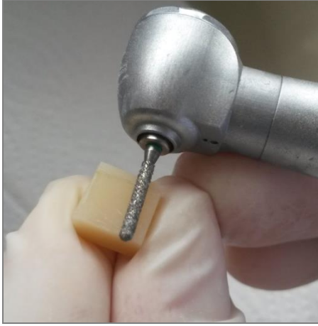
Şekil 3.28: Lava Ultimate örnekler elmas frezle yüzey pürüzlendirme işlemi uygulanması
