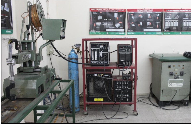
Şekil 8.10. Plazma kaynak makinesi genel görünümü ve donanımı
