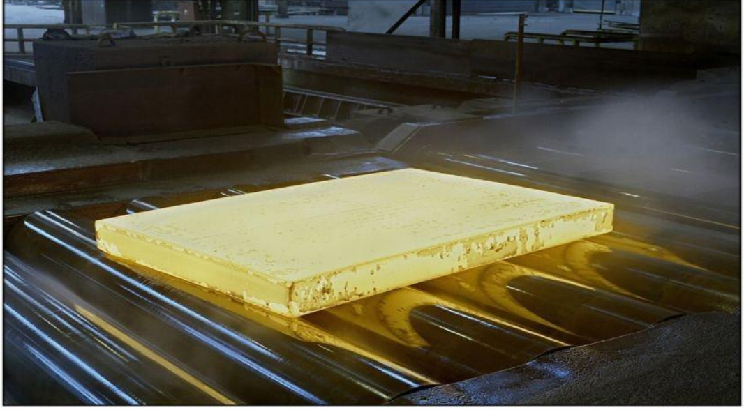
Şekil 2.6. Üretim hattındaki Hardox 400 çeliği [19].
