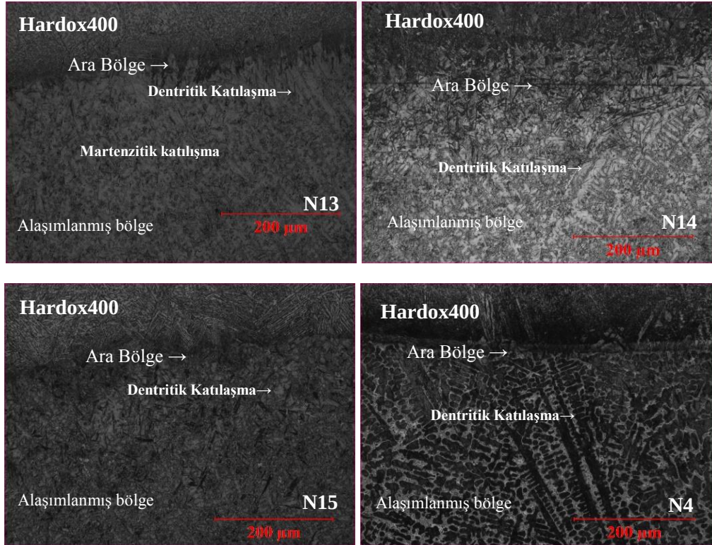
Şekil 9.20. TiC toz karışımıyla elde edilen kompozit kaplama/ alt tabaka arayüzeyinin optik görüntüleri
