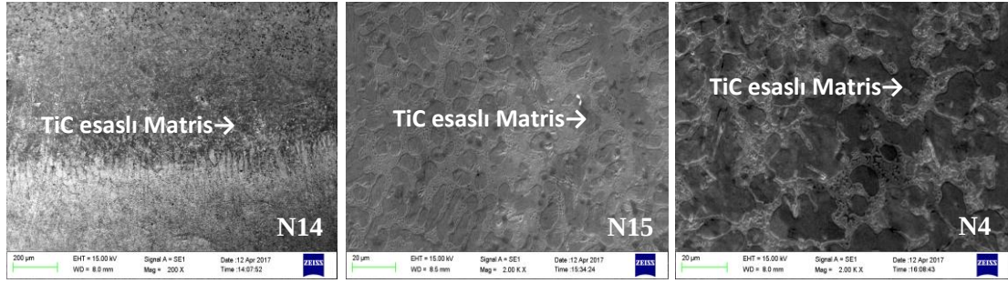
Şekil 9.21. TiC toz karışımıyla alaşımlanmış numunelerin kaplama tabakasının SEM görüntüleri
