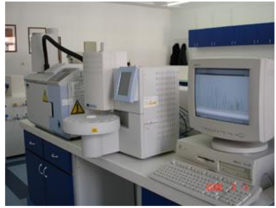
 ekil 3.3. Clevenger distilasyon cihazında elde edilen g l yađının GC/MS cihazında analizi
