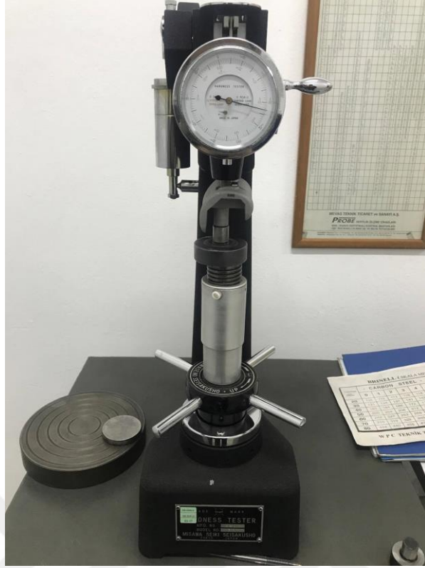
Şekil 5.23 : Misawa Seiki sertlik ölçüm cihazı.
