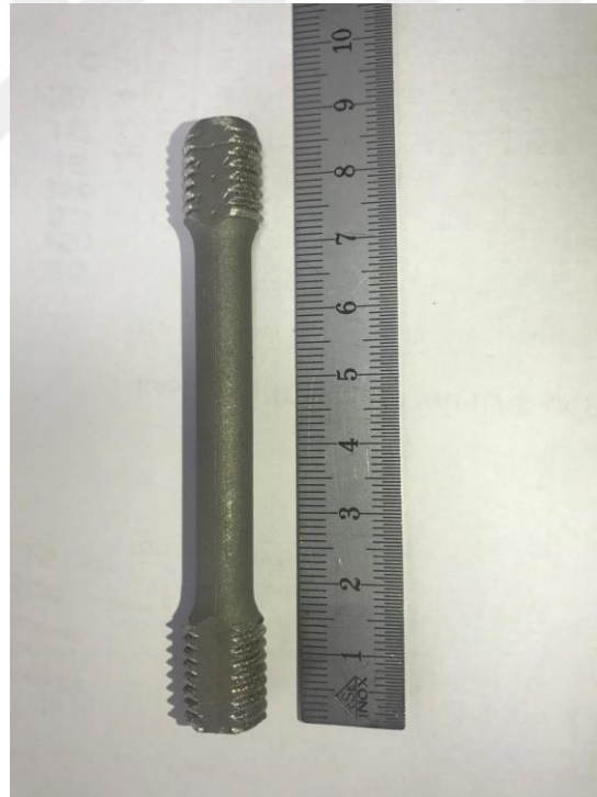
Şekil 5.22 : Çekme test numunesi.
