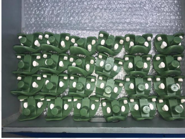
řekil 5.9 : Seramik maaları monte edilen femoral komponentler.
