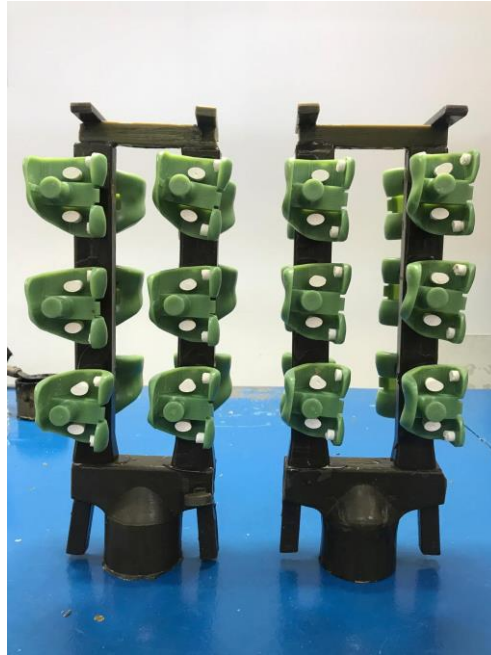
řekil 5.10 : Mum model salkımı haline getirilen femoral komponentler.
