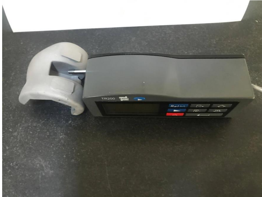
Şekil 5.24 : TR200 portatif yüzey pürüzlülük ölçüm cihazıyla ölçüm yapılması.
