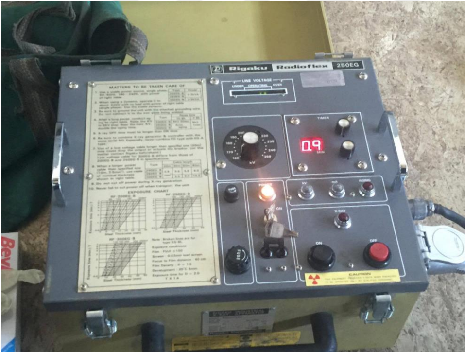
Şekil 5.28 : Radioflex 250EG X-ışını radyografik muayene cihazı.
