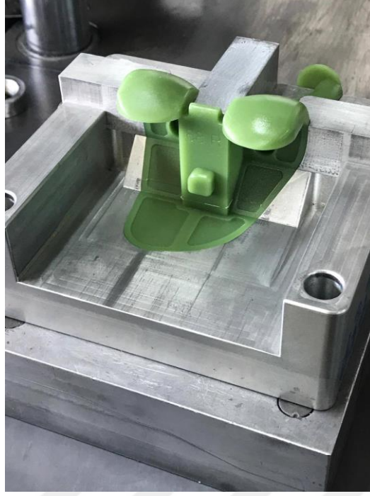
Şekil 5.7 : Femoral komponent mum model enjeksiyon kalıbı.
