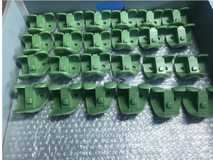
Şekil 5.8 : Femoral komponent mum modeller.
