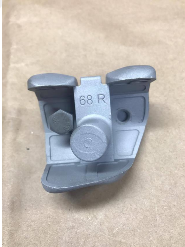
Şekil 5.19 : M8 vida kontrol işlemi.
