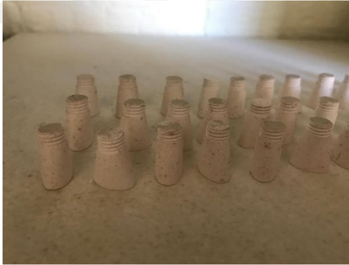
Şekil 5.6 : Üretimi tamamlanmış seramik maçalar.
