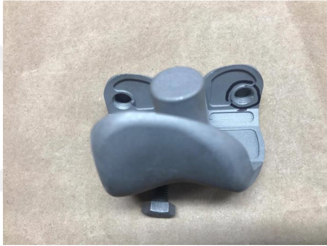
Şekil 6.7 : Vida adımı bozuk parça.
