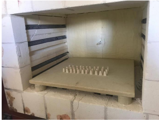
Şekil 5.4 : Seramik Maça bağlayıcı giderme ve pişirme fırını.
