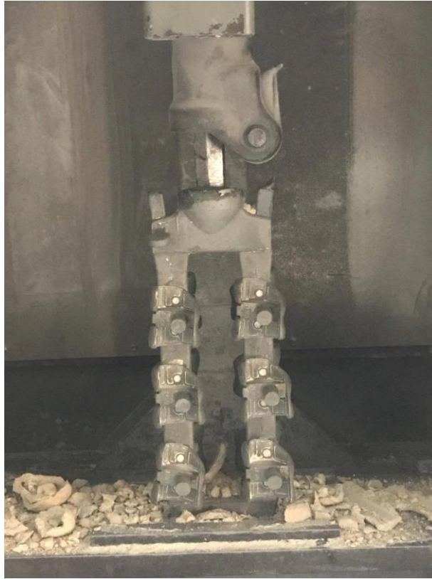
Şekil 5.16 : Seramik kabuk kırma işlemi.
