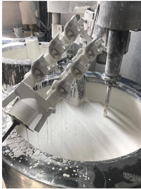
Şekil 5.12 : Seramik banyosuna daldırıldıktan sonra mum model salkımı.
