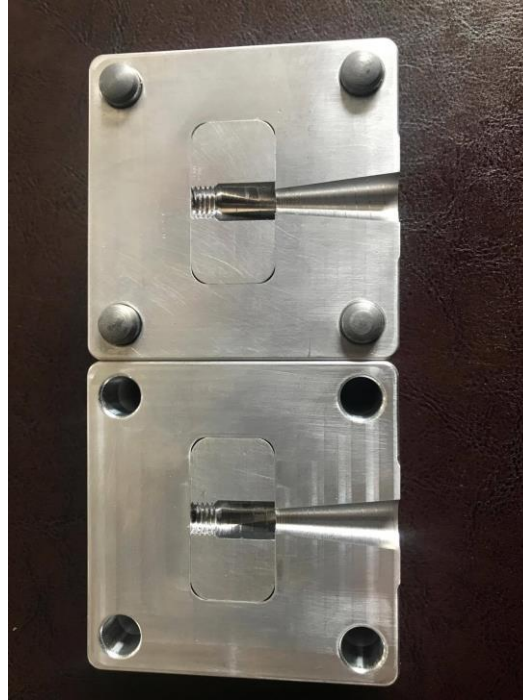
Şekil 6.1 : 7075 serisi alüminyum alaşımından yapılan seramik maça kalıbı.
