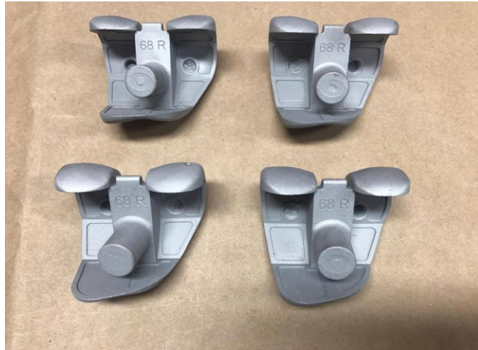
Şekil 6.5 : Peg yuvası hatalı parçalar.
