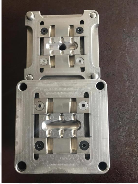
Şekil 6.2 : 4140 çelik malzemedan yapılan seramik maça kalıbı.
