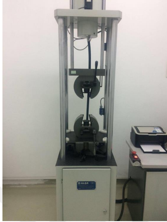
Şekil 5.21 : Alşa 10 ton çekme cihazı.
