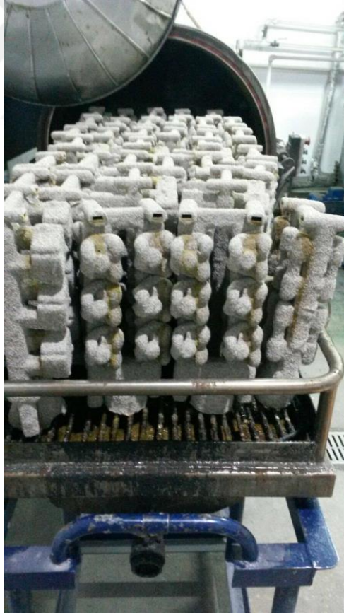
Şekil 5.13 : Otoklav sonrası mumu geri alınan seramik salkımlar.
