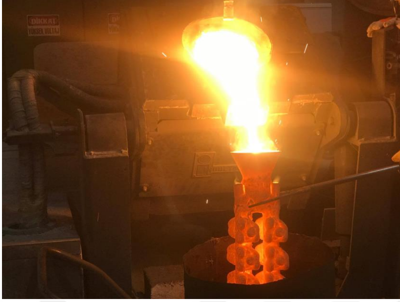
Şekil 5.15 : ASTM F75 Co-Cr-Mo alaşımının döküm işlemi.
