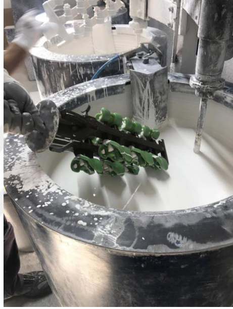
Şekil 5.11 : Seramik banyosuna daldırılmadan önce mum model salkımı.
