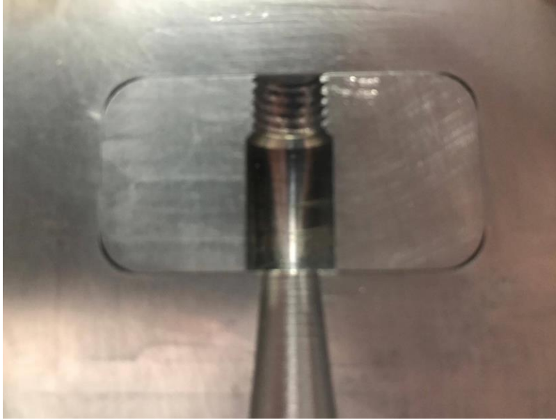
Şekil 6.3 : 7075 serisi alüminyum alaşımından yapılan ve aşınmış seramik maça kalıbı.
