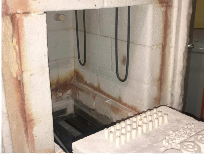
Şekil 5.5 : Seramik maça sinterleme fırını.
