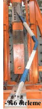
Şekil 5.43 : TB-16, TB-17, TB-18 numuneleri (Kutu 70x70x4) yatay yük - görelî öteleme oranı eğrileri, burkulma modları ve kopma sonrası hasar seviyeleri.
