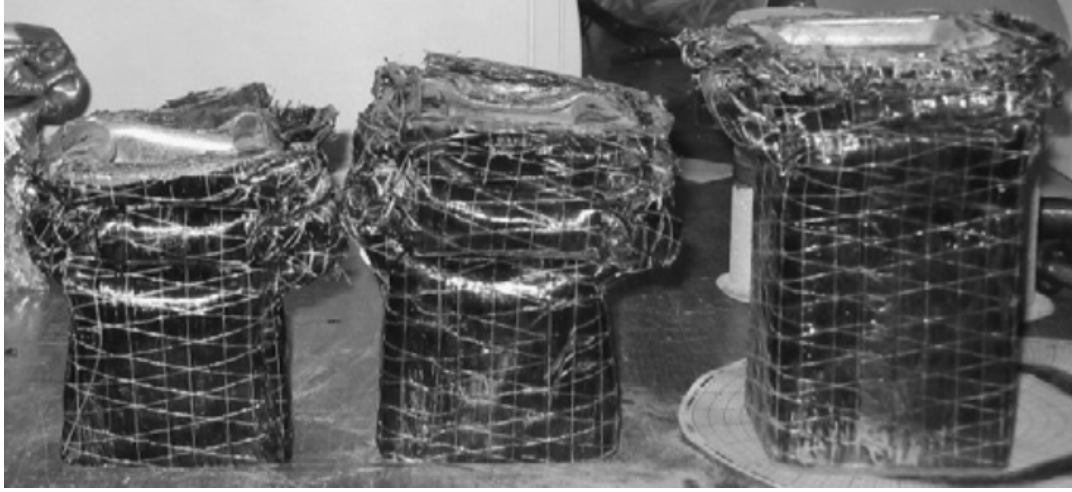
Şekil 2.8 : CFRP elemanlarla güçlendirilmiş çelik tüp kesitlerde göçme modları (Bambach ve Elchalakani, 2007).
