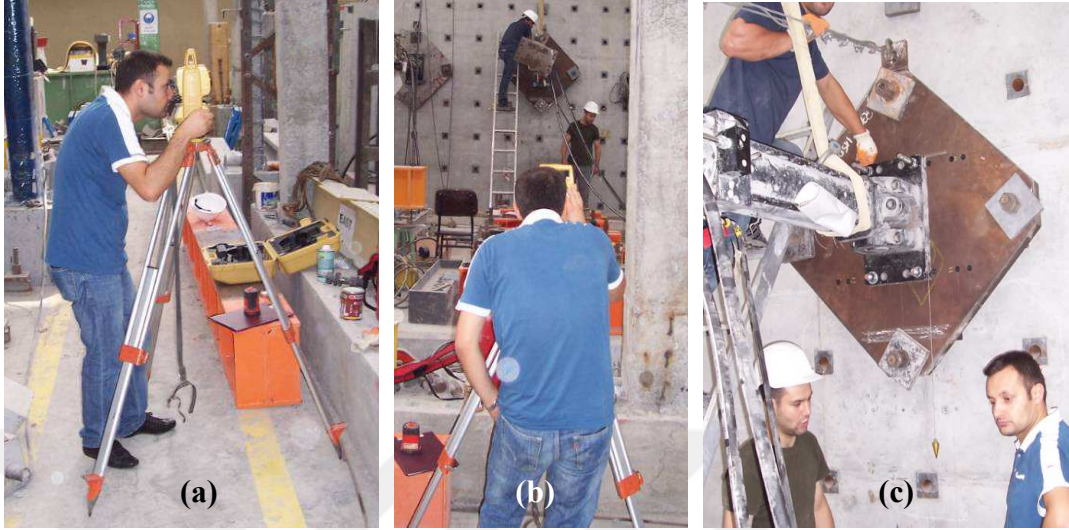
Şekil 3.8 : Ankraj ve hidrolik veren montajı: (a) ve (b) Teodolit ile eksen çakıştırma. (c) Hidrolik veren montajı.
