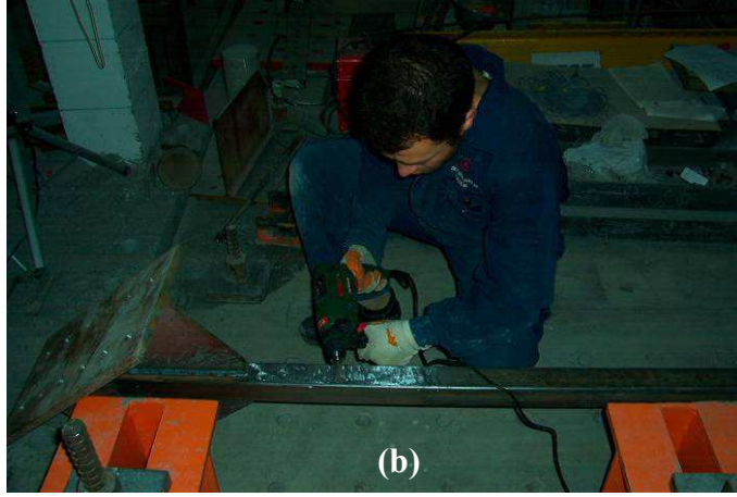
Şekil 3.31 : Laboratuvarda yüzey temizliği uygulamaları: (a) CFRP plaka yapıştırılacak bölgede yüzey hazırlığı. (b) CFRP kumaş yapıştırılacak bölgede yüzey hazırlığı.
