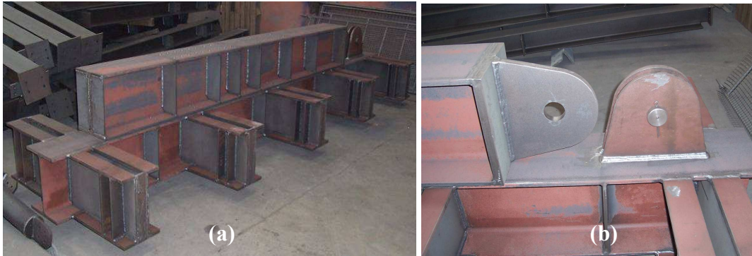
Şekil 3.3 : Deney düzeneğinin fabrikadaki durumu: (a) Yükleme kolunu ve temel kirişi. (b) Mafsal bölgesi.
