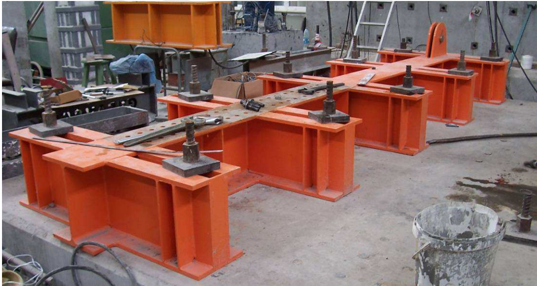
Şekil 3.9 : Temel kirişinin güçlü döşemeye bağlanmış durumu.
