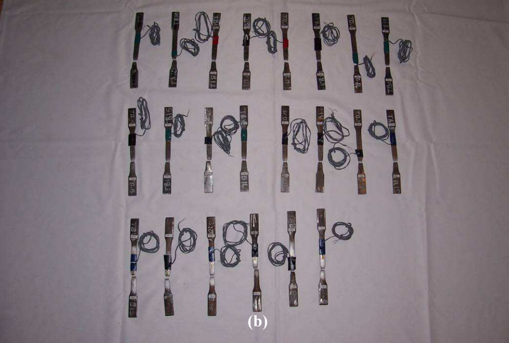
Şekil 3.24 : Deney sonrası çekme numunesi görünümleri: (a) İlk grup. (b) İkinci grup.
