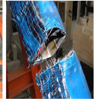
Şekil 5.43 : TB-16, TB-17, TB-18 numuneleri (Kutu 70x70x4) yatay yük - görelî öteleme oranı eğrileri, burkulma modları ve kopma sonrası hasar seviyeleri.
