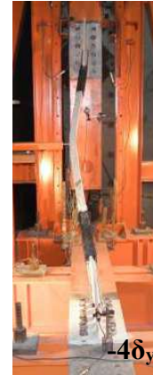
Şekil 5.27 : TB-10, TB-11, TB-12 numuneleri (Kutu 50x50x4) yatay yük - görelî öteleme oranı eğrileri, burkulma modları ve kopma sonrası hasar seviyeleri.
