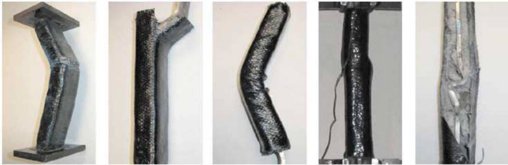
Şekil 2.9 : CFRP ile sarılmış numunelerin deney sonrası görünüşleri (Ekiz ve El-Tawil, 2008).
