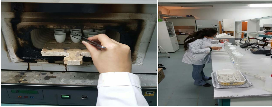
Şekil 3.17. Domates bitkisinin meyve ve yapraklarını kuru yakma yöntemi ile analize hazırlanması
