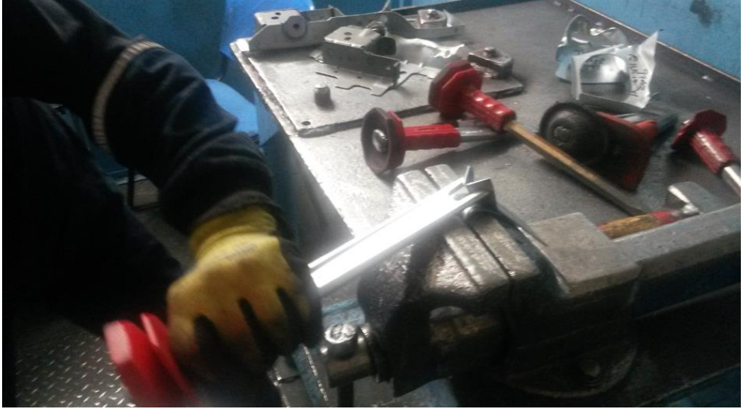
Şekil 4.58 Kaynak parametre sınır değerleri belirlenebilmesi için numunelere Tahribatlı Muayene uygulanması
