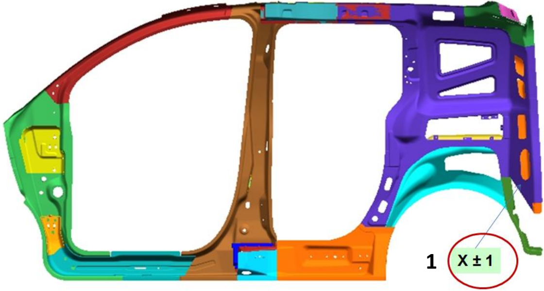
Şekil A.2 Yan çerçeve kompleksine göre yan braketin toleransı
