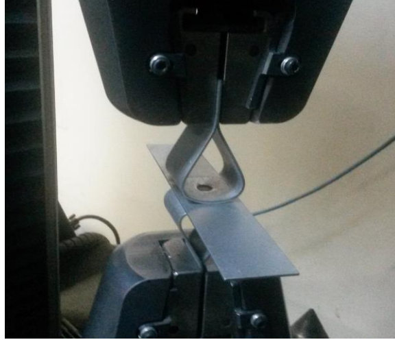
Şekil 4.57 Üçlü sac numunelerinin çekme testlerinin gerçekleştirilmesi
