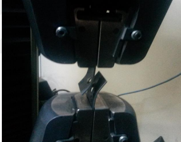
Şekil 4.56 Numunelerin sıyırma testlerinin gerçekleştirilmesi
