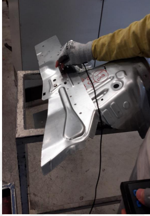
řekil 4.50 Komplelere Ultrasonik Test uygulama rneęi
