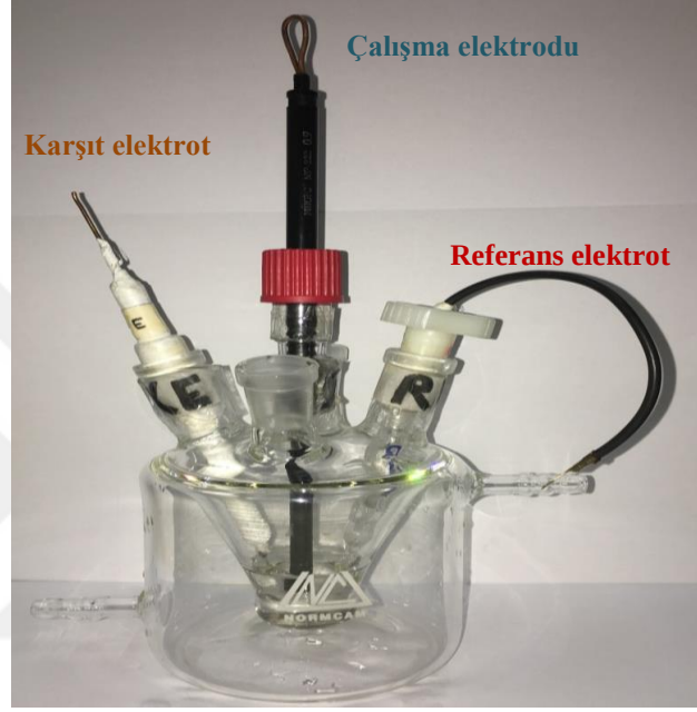
Şekil 2.6. Voltametric ölçümlerde kullanılan hücre ve hücre bileşenleri.
