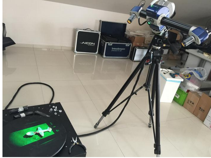
Şekil 5.3. Smartscan model optik tarayıcı ile parçanın taranması
