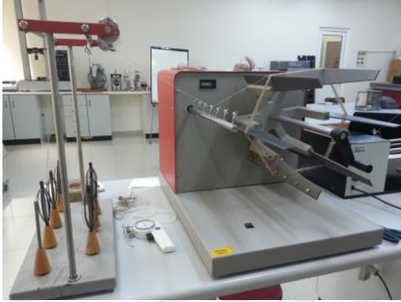
Şekil 14: İpliğin numara tayini için çıkırıktaki sarılması.
