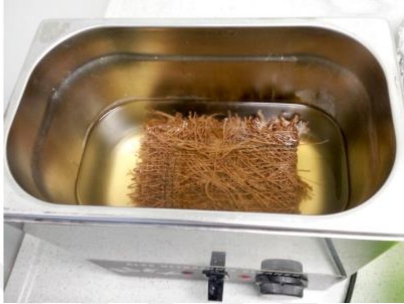
Şekil 20: Ultrosonik banyoda işlem.
