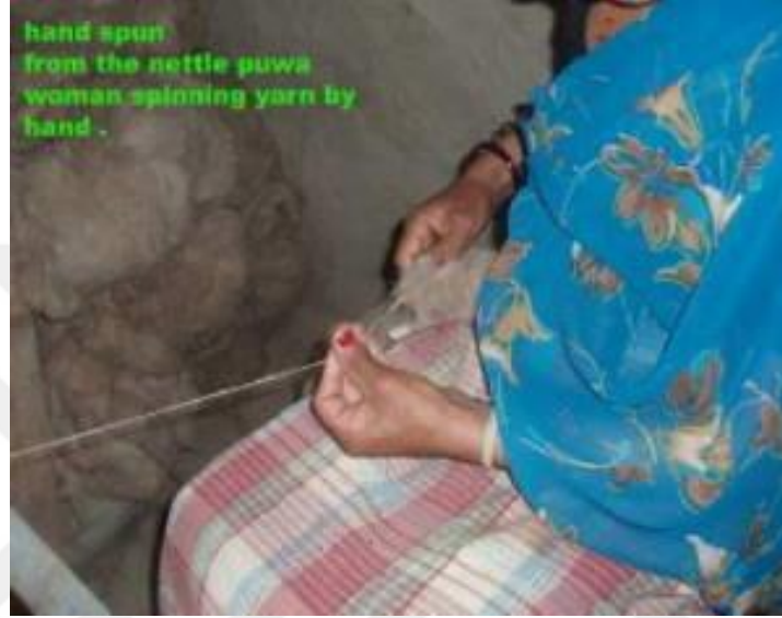
Şekil 8: ısırgan ipliğinin elde eğilmesi işlemi (URL-3, 2015).
