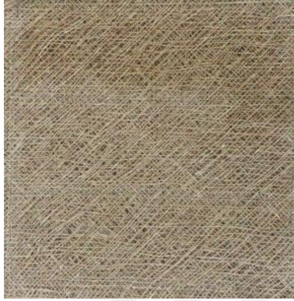
Şekil 18: Uygulamada kullanılan çok eksenli yüzey.
