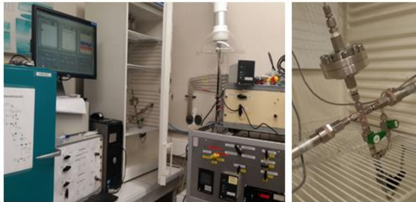
Şekil 6.14 Gaz geçirgenlik ölçüm sistemi ve gaz geçirgenliği ölçüm aparatı
