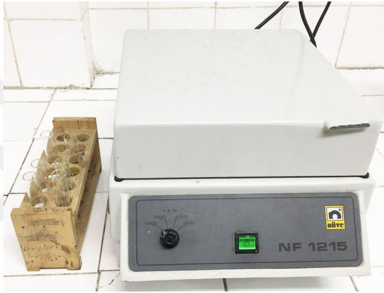
Şekil 3.2. Nüve NF 1215 santrifüj cihazı
