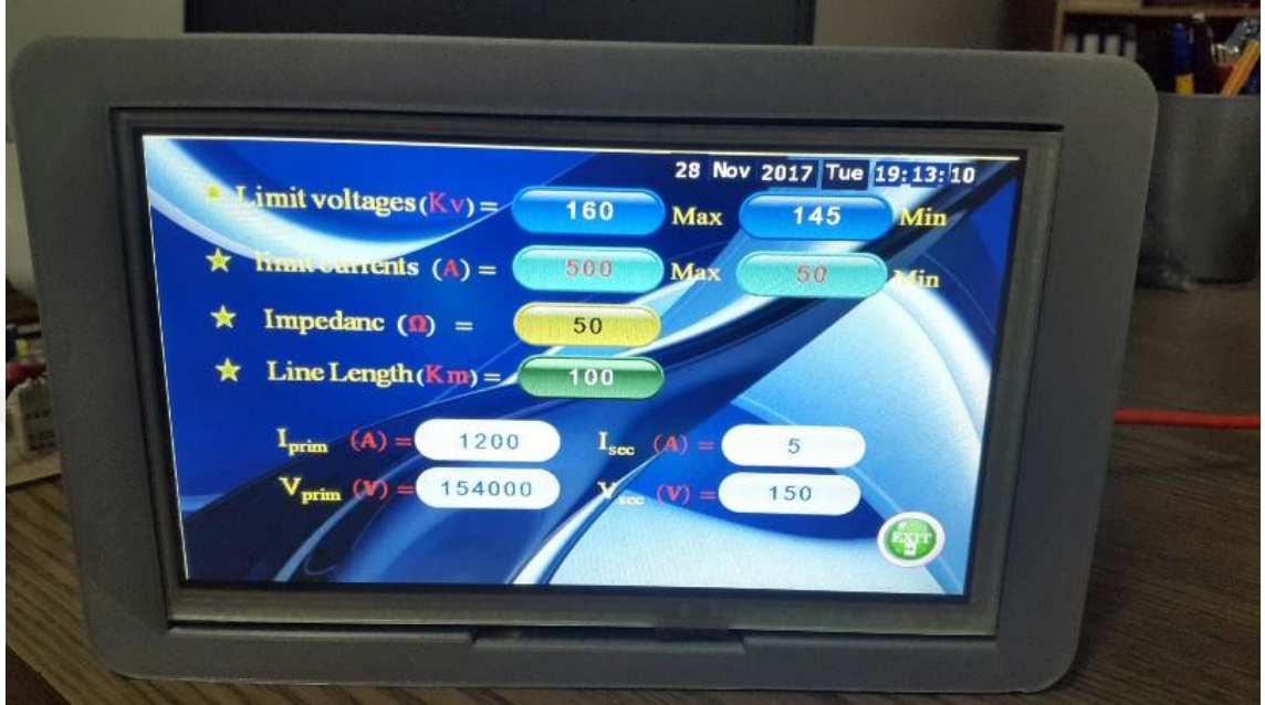
Şekil 3.10 Prototip Mesafe Rölesinin Test Sürecinde Alınmış Ayar Menüsü Görüntüsü
