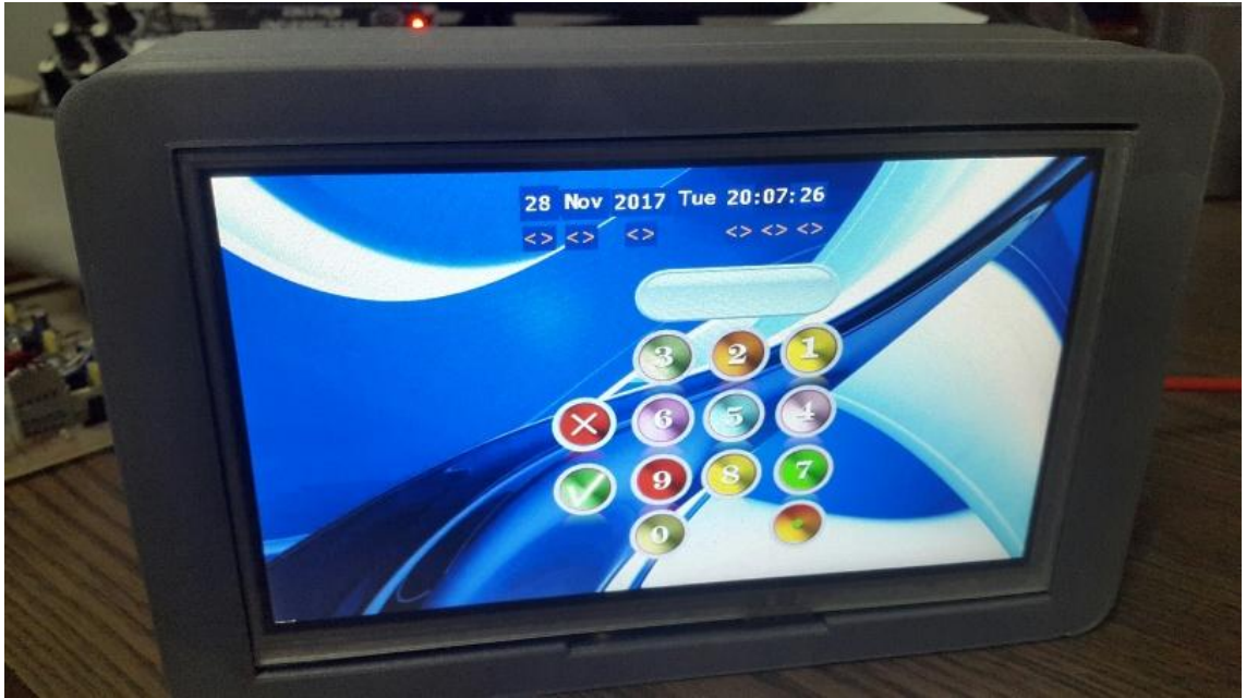
Şekil 3.12 Prototip Mesafe Rölesinin Tarih Ayar ve Veri Giriş Ekranı Görüntüsü
