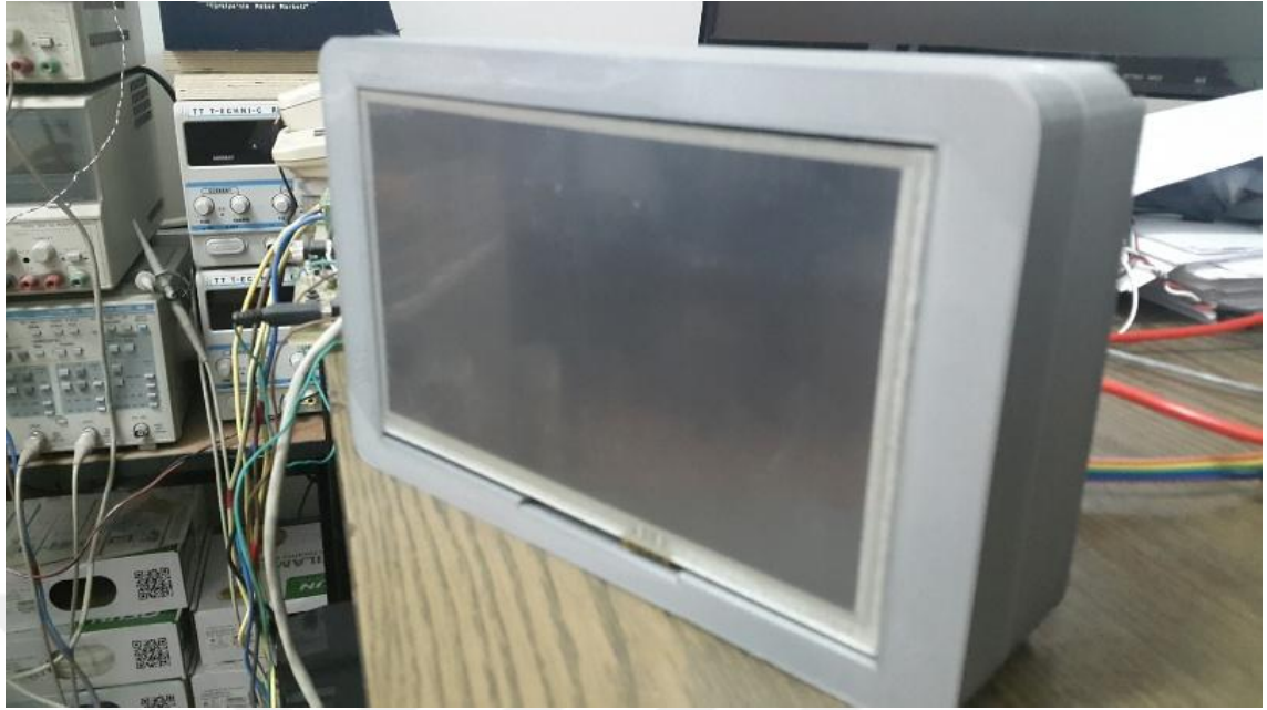
Şekil 3.8 Prototip Olarak Gerçekleştirilen Mesafe Rölesi
