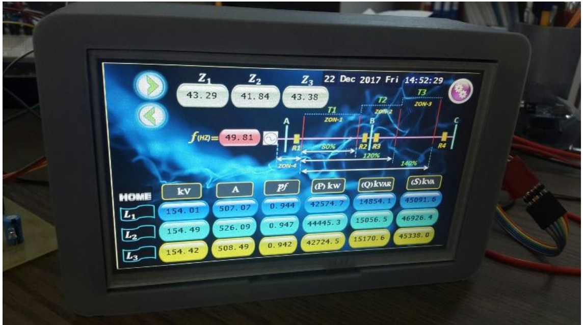
Şekil 3.9 Prototip Mesafe Rölesinin Test Sürecinde Alınmış Ana Ekran Görüntüsü
