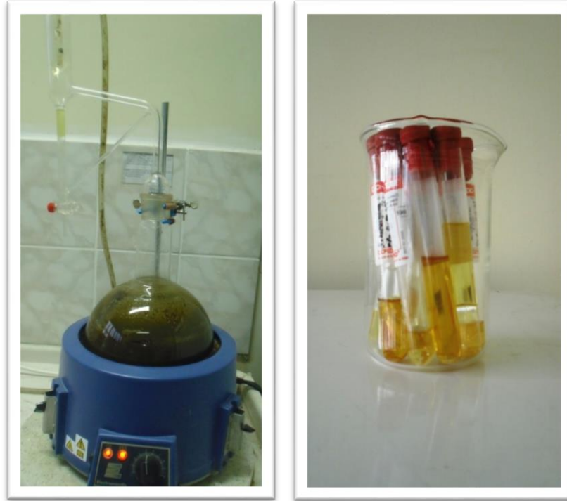
Şekil 3.12. Clevenger cihazı ve elde edilen Thymus türleri uçucu yağları
