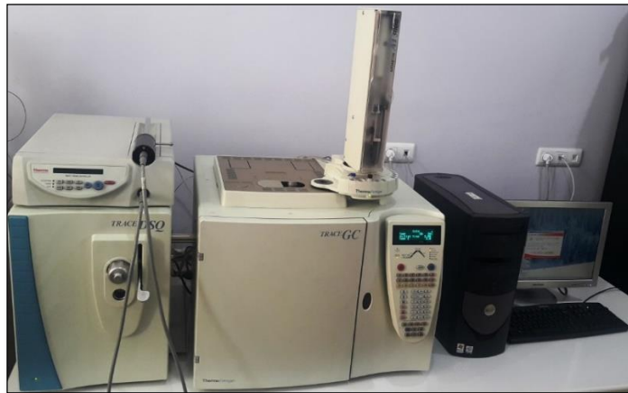
Şekil 3.13. Thymus uçucu yağlarının içerik analizlerinin yapıldığı GC-MS cihazı (Atatürk Üniversitesi Fen Fakültesi Kimya Bölümü)
