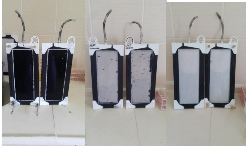
Şekil 18. MF modüllerinin temizlik öncesi ve sonrası durumları
