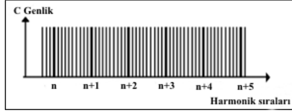
Şekil 1.3 IEC 6100-4-7’ye göre genel spektrum çözünürlüğü (50-Hz için) (IEC, 2002).
