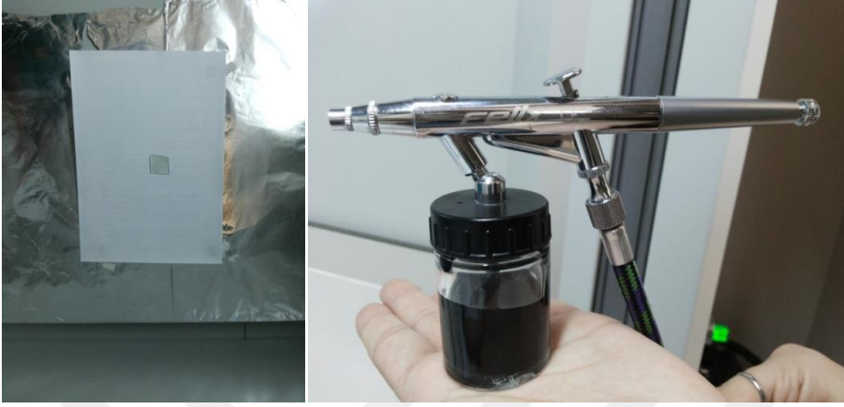
Şekil 3.10. Spreycaplama metoduna ait aparat ve PEDOTların spreycaplama metoduyla kaplanması
