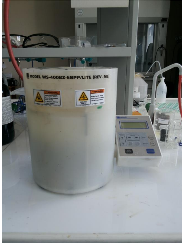
Şekil 3.2. Substrat yüzeyine polimer filmin kaplandığı döndürme yöntemiyle kaplama cihazı
