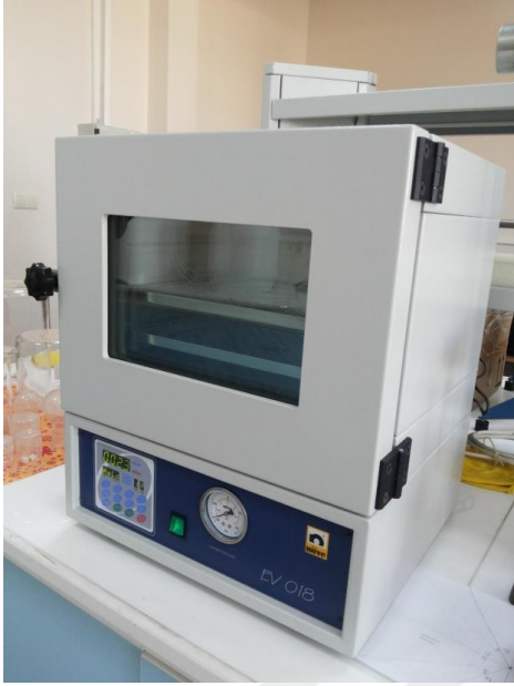
Şekil 3.5. Selecta markalı “Vaciotem- T” vakum etüvü
