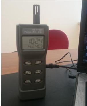
Şekil 5.7. Ölçümlerde kullanılan CO 2 &Temp.&RH metre cihazı
