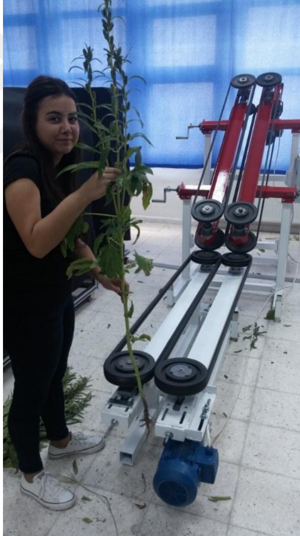
Şekil 4.10. Susam bitkilerinin taşıyıcı banda verilme işlemi
