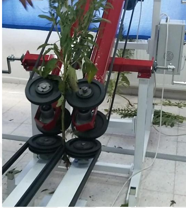
Şekil 4.11. Yolucu-Sökücü düzenin susam bitkisini yakalaması
