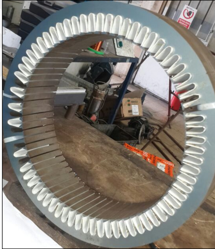
Şekil 6.6. Polyester film malzemenin stator oluklarına yerleşimi.
