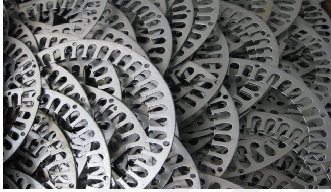
Şekil 6.4. Kalıplarda kesilen elektrik sacları.
