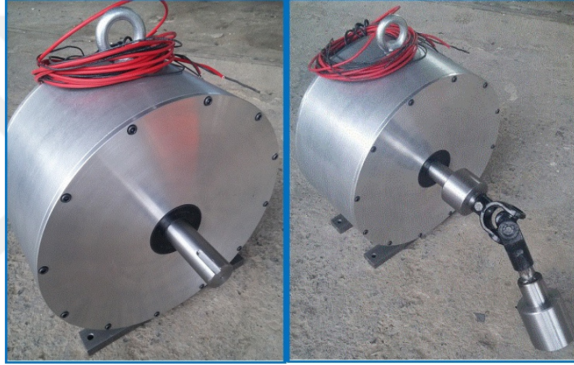
Şekil 6.19. Tasarlanan 4 kW generatörün prototipi ve kaplin bağlantısı.
