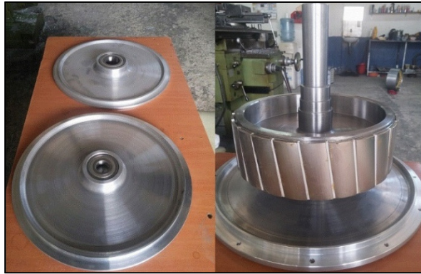
Şekil 6.17. Revizyonu tamamlanan mil parçası ve kapaklar.
