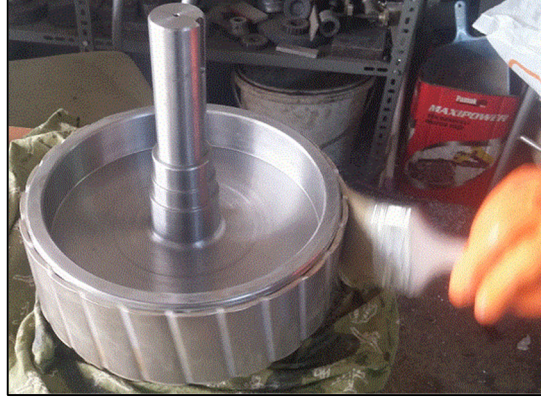
Şekil 6.18. Mıknatıslara kaplama işlemi.
