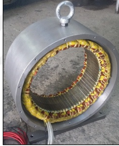
Şekil 6.16. Statorun dış gövdeye monte edilişi.
