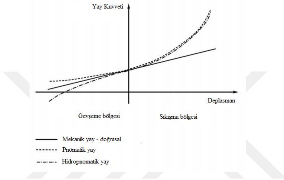
Şekil 1.2 : Mekanik ve gaz yaylanmalı sistemlerin kuvvet-deplasman eğrileri (Bauer, 2011)
