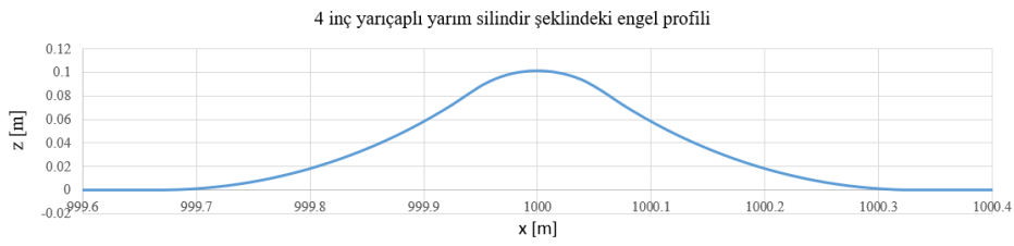
Şekil 2.31 : Yarım silindirik şeklindeki engel geometrisi.
