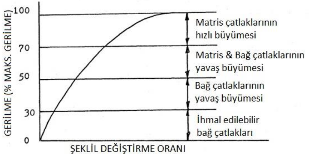
Şekil 1.2 : Betonun şematik gerilme-şekil değiştirme grafiği [4].
