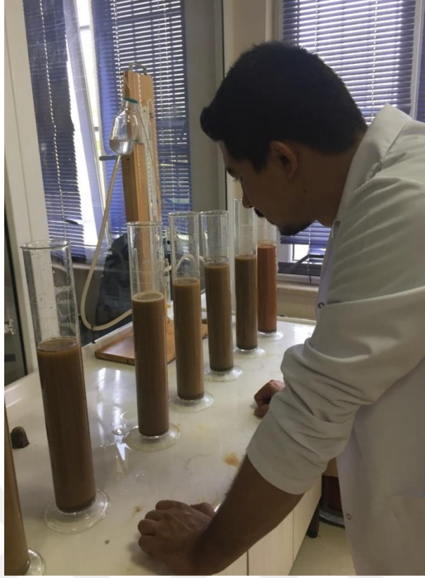
Şekil 3.15. Silindirde bulunan örnekteki hidrometre değerin okunması
