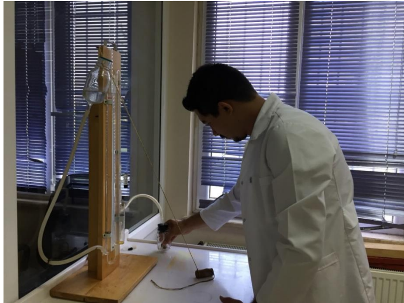
Şekil 3.16. Scheibler kalsimetresinde bulunan HCl konulduğu cam şişenin çalkalanması
