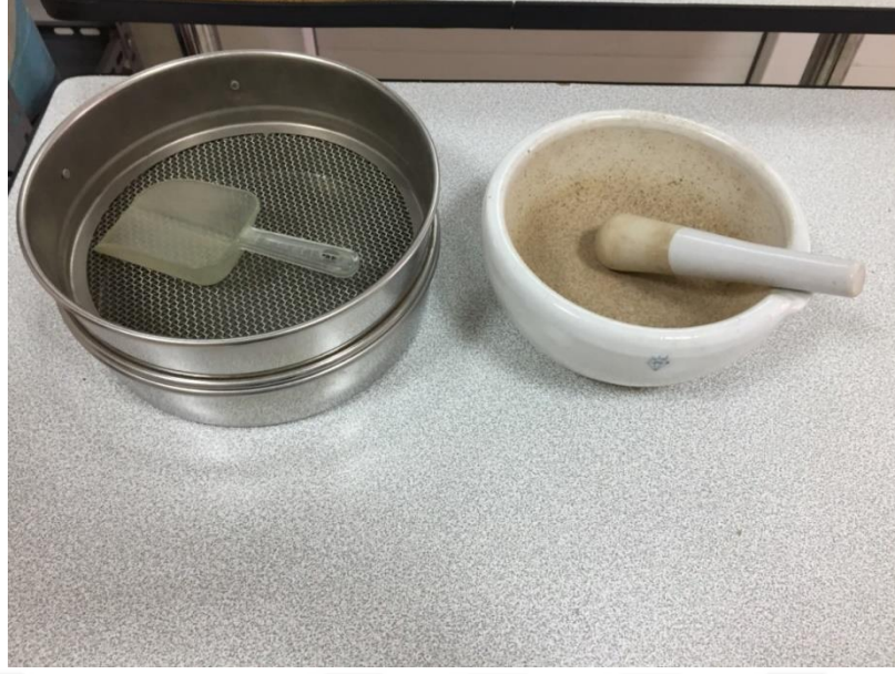
Şekil 3.13. Toprakları analize hazırlamak amacıyla kullanılan havan ve 2 mm'lik elek
