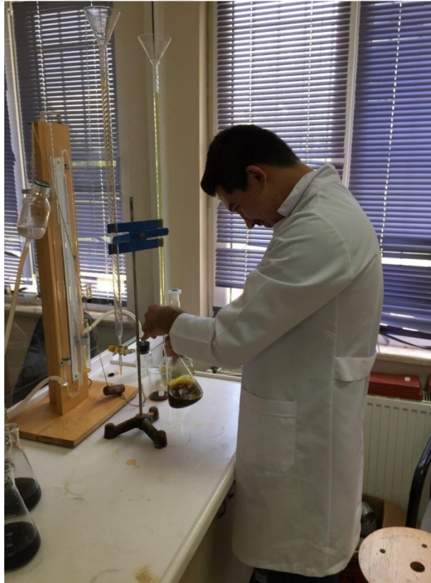
Şekil 3.20. Organik madde belirlenmesinde titrasyon işleminin yapılması
