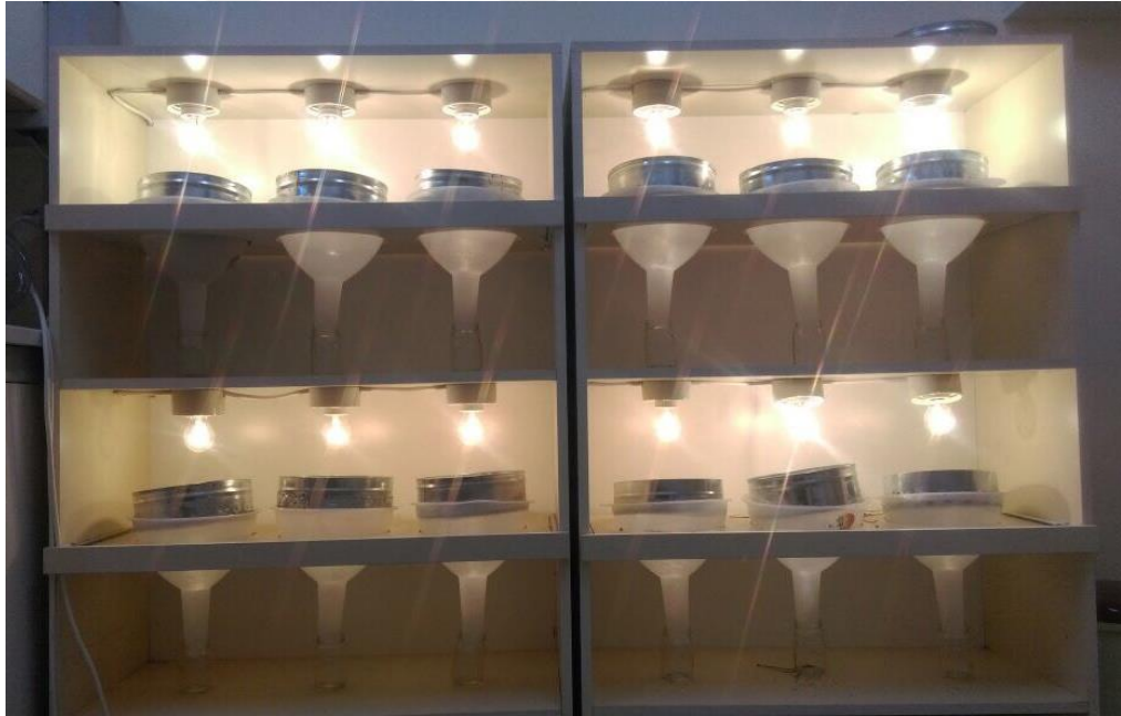
Şekil 2.2. Birleştirilmiş Berlese hunilerinden oluşan toprak akarlarını ayıklama düzeneği.
