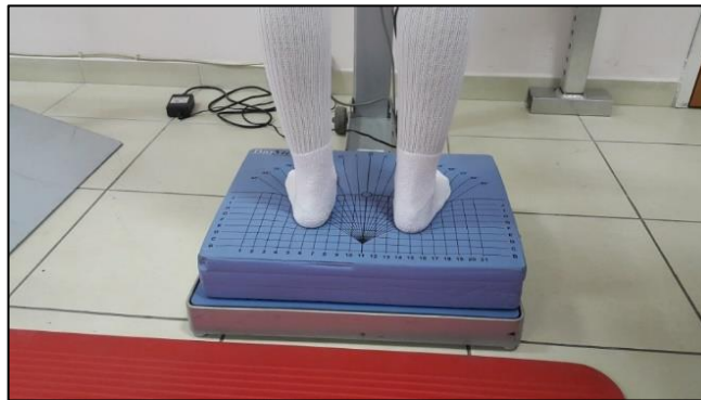
Şekil 3.3. Biodex balans sistemi viskoelastik köpük zemin.
