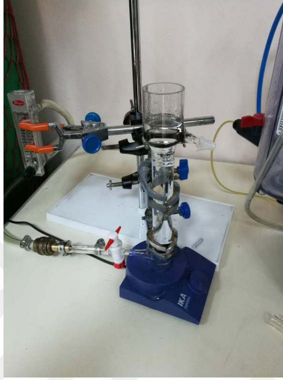
Şekil 3. 20: Mikro-flotasyon deney düzeneği.
