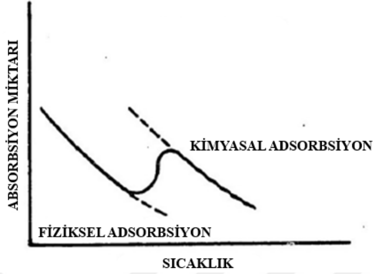
Şekil 2. 15: Fiziksel adsorbsiyon ve kimyasal adsorbsiyon arasındaki geçiş bölgesini gösteren adsorbsiyon miktarına karşı sıcaklık adsorbsiyon izobarı (Jordens vd., 2013)
