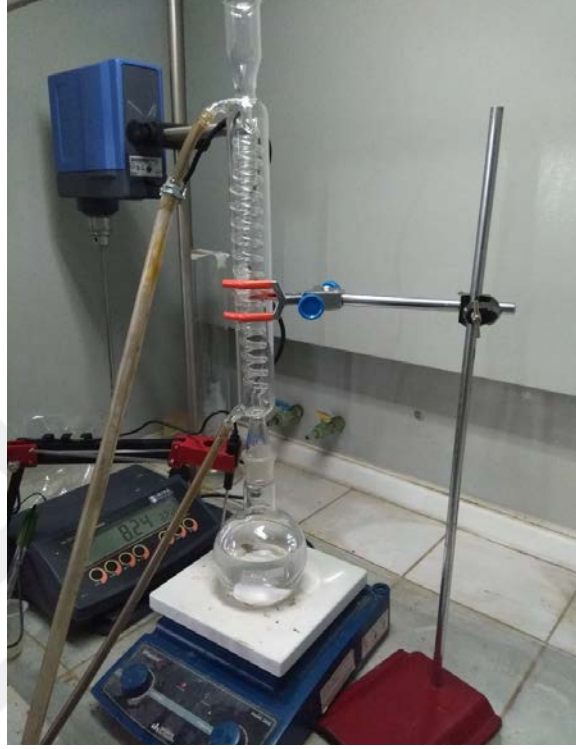
Şekil 3.22: Liç deneylerinde kullanılan deney düzeneği.
