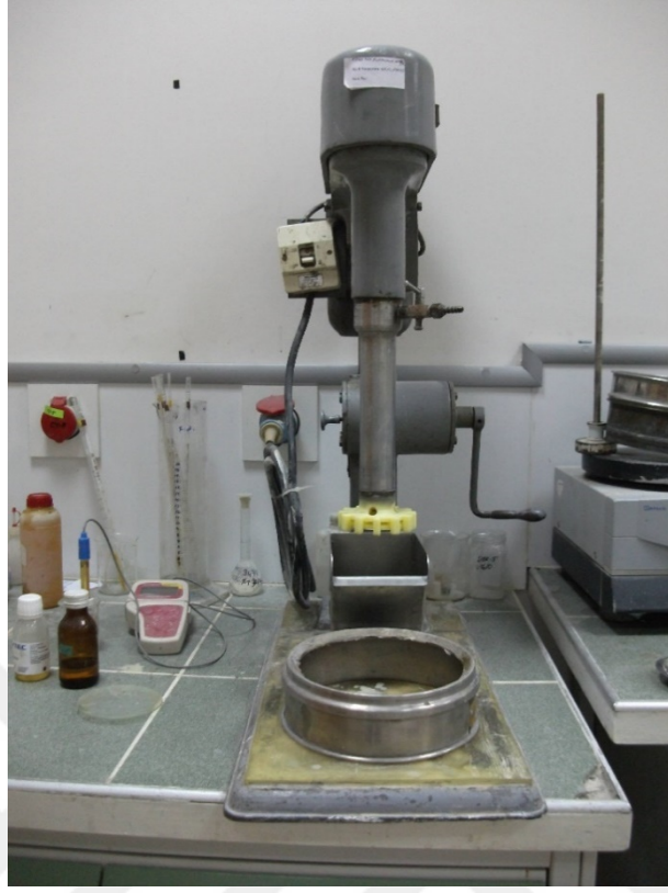
Şekil 3. 21: Deneylerde kullanılan Denver flotasyon cihazı ve deney düzeneği.
