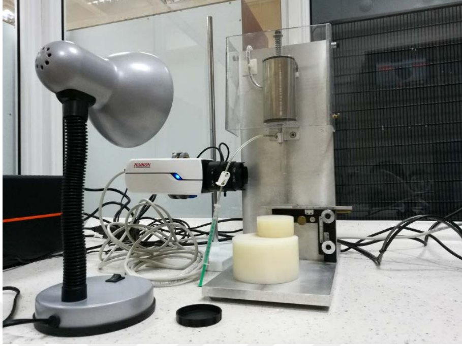
Şekil 3. 19: Kabarcık-tane etkileşimi deney düzeneği.
