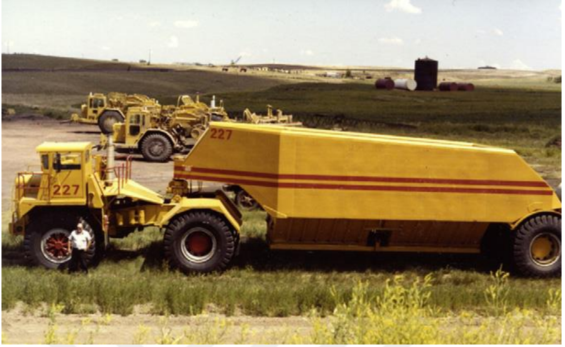
Şekil 4.2 100 ton taşıma kapasitesine sahip kömür kamyonu[20]
