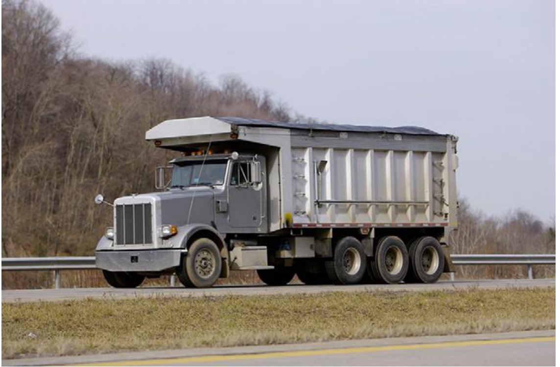
Şekil 4.3 25 ton taşıma kapasitesine sahip kömür kamyonu[20]
