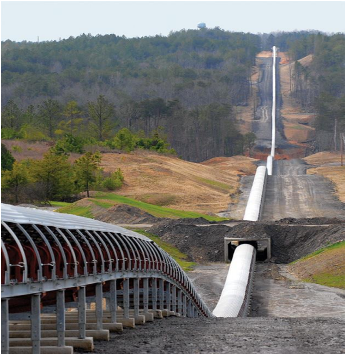
Şekil 4.5 Karadan Konveyör sistemi[20]
