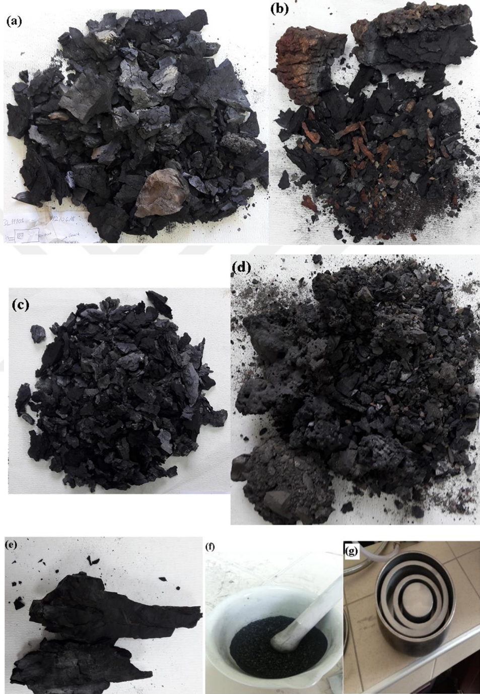
Şekil 4.14: a) Büyük blok oyuk üstü özerk bölgesinden alınan çarlar, b) İlk linyit bloğu giriş sağ taraftan alınan çarlar, c) Oyuk duvarları ilerisinden alınan çarlar, d) Bu çalışmada kullanılan oyuk bölgesinden alınan yüksek verimde gazlaşmış linyit, kül ve aglomere parça karışık çarlar, e) Bu çalışmada kullanılan linyit numuneleri, f) Havan, g) Halkalı öğütücü.
