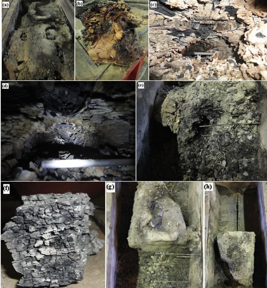
Şekil 4.5: a) Deney sonlandırıldıktan sonra reaktör içerisindeki ilk görüntü, b) Reaktörün ön kısmından çıkarılmış sinterleşme ve aglomerasyona uğrayan linyit ve kil parçalarının birleşerek oluşturduğu çarlaşmış yapı, c) Oyuk oluşumunun girişten ve oyuk duvarlarında gazlaşmayı doğrulayan yapıdaki gazlaşmış linyit numunesinin görüntüsü, d) Kavitasyon, e) Kavitasyonun ileri bölgelerdeki durumu, f) Kavitasyon bölgesinden çıkarılan gazlaşmış linyit, g) 2. linyit bloğu, h) 2. linyit bloğu ve kanal.
