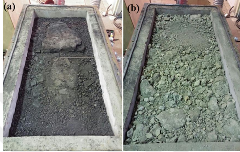
Şekil 4.2: a) Yerleştirilen linyitlerin son hali, b) Kil parçalarının yerleştirilmiş hali.
