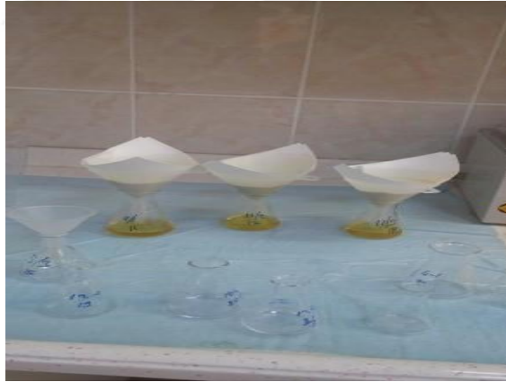
Şekil 3.2. Aflatoksin ekstraktının süzölme işlemi.
