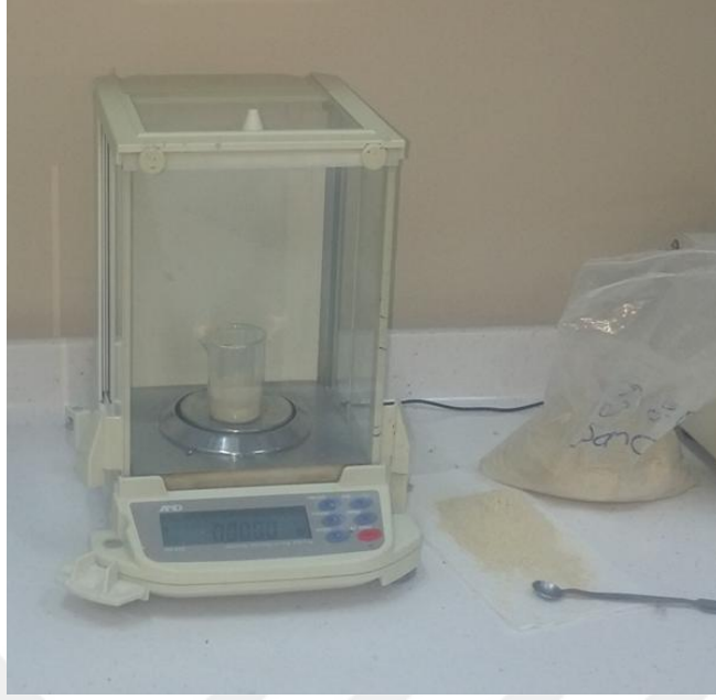
Şekil 3.1. Aflatoksin analizine tabii tutulacak yem örneğinin tartılması.
