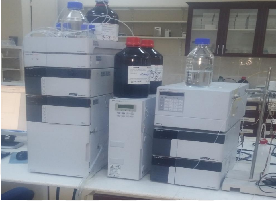
Şekil 3.5. Kobra Cell bağlı HPLC sistemi.
