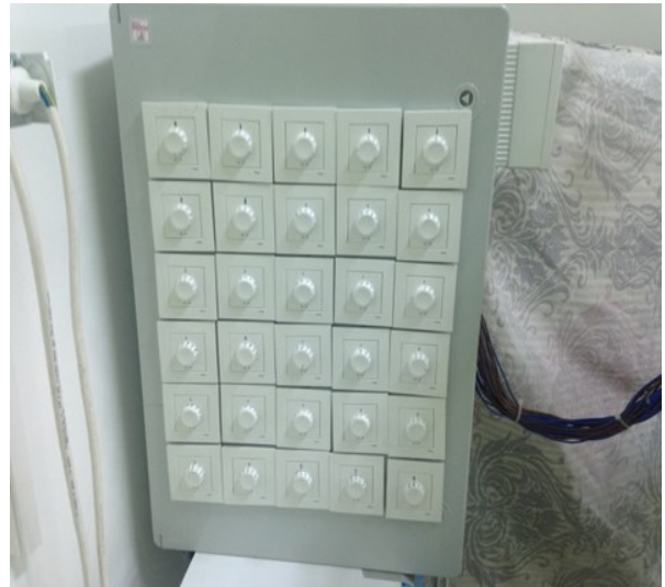
Şekil 4.3. Deneyde kullanılan güneş simülatörü ve kontrol paneli
