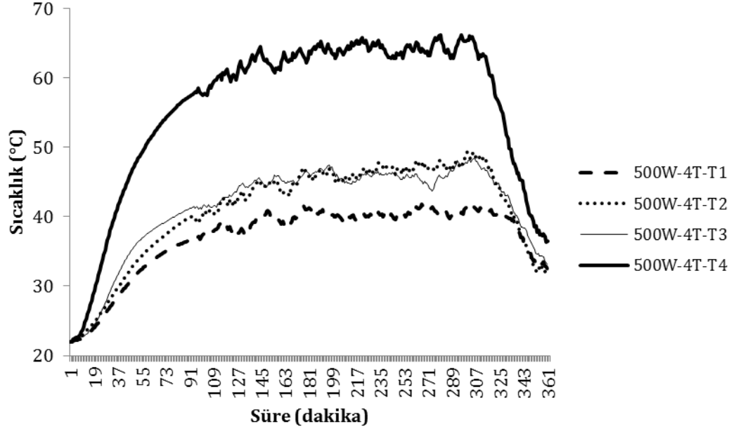
Şekil 5.10. 500 W/m 2 ısıtım koşullarında 12 tuğlalı tasarımlı kolektörün tuğla sıcaklıklarının değişimi
