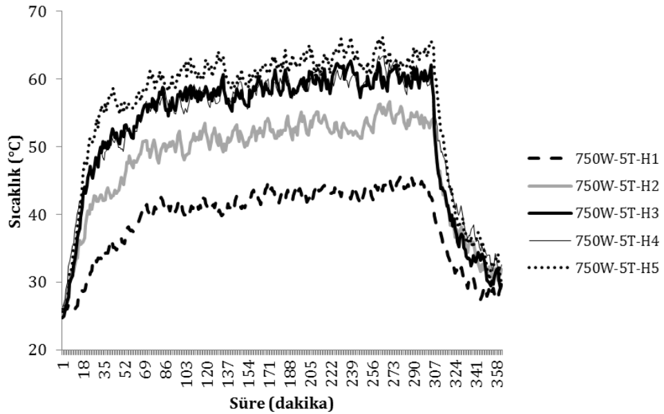
Şekil 5.18. 750 W/m 2 ısıtım koşullarında 15 tuğlalı tasarımı kollektörün hava sıcaklıklarının değişimi
