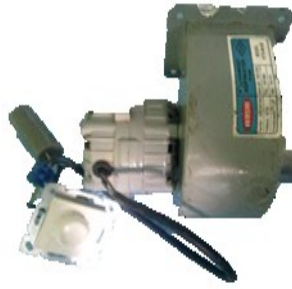
Şekil 4.4. Deneyde kullanılan radyal fan ve dimmer anahtarı
