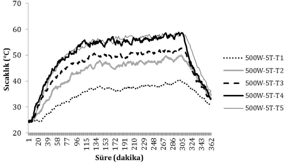
Şekil 5.7. 500 W/m 2 ısıtım koşullarında 15 tuğlalı tasarımlı kollektörün tuğla sıcaklıklarının değişimi
