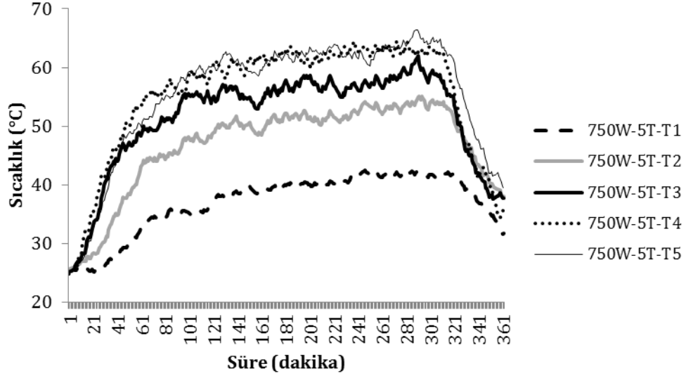
Şekil 5.20. 750 W/m 2 ışınlm koşullarında 15 tuğlalı tasarımı kollektörün tuğla sıcaklıklarının değışimi
