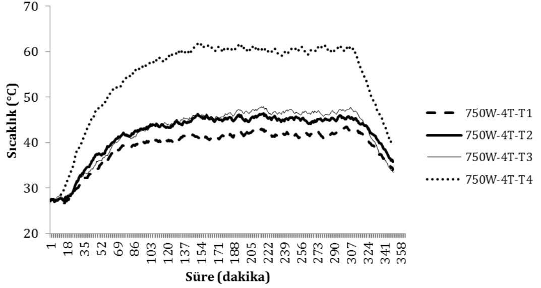
Şekil 5.23. 750 W/m 2 ışınlm koşullarında 12 tuğlalı tasarımli kollektörün tuğla sıcaklıklarının değışimi
