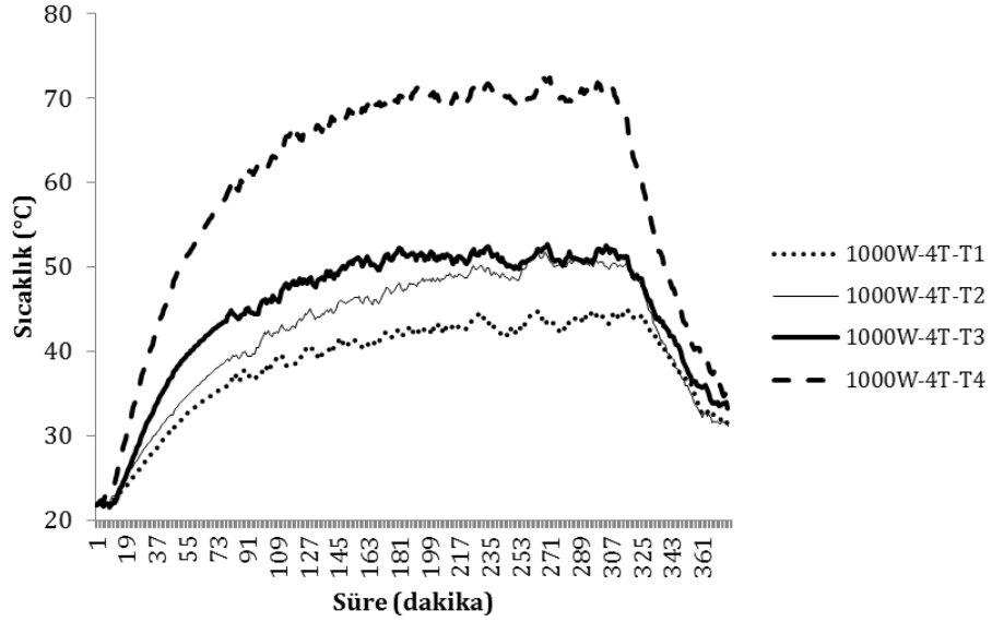
Şekil 5.36. 1000 W/m 2 ışınlm koşullarında 12 tuğlalı tasarımı kollektörün tuğla sıcaklıklarının değışimi
