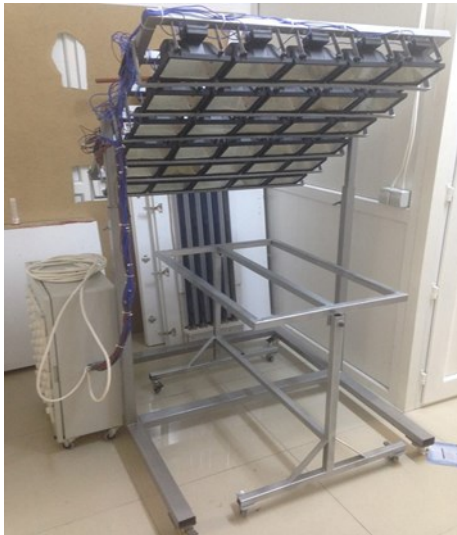
Şekil 4.3. Deneyde kullanılan güneş simülatörü ve kontrol paneli
