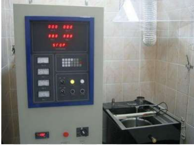
Şekil 5.1 : Mikro ark oksidasyon cihazı.
