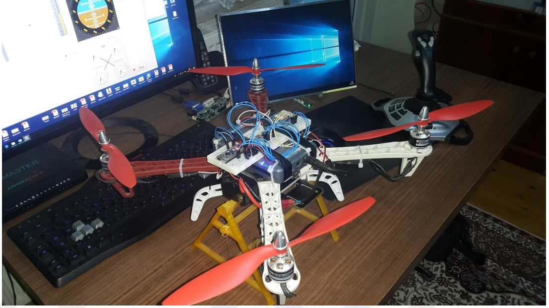
Şekil 4.11: myRIO kontrollü dört rotorlu insansız hava aracımız
