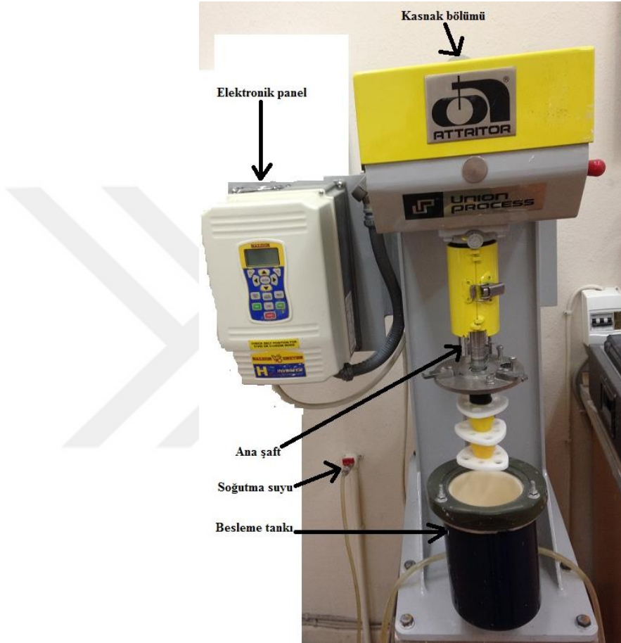
Şekil 4.1 : 750 cc besleme tankı ve elektronik paneli ile birlikte 01-HD marka Attritor cihazı.
