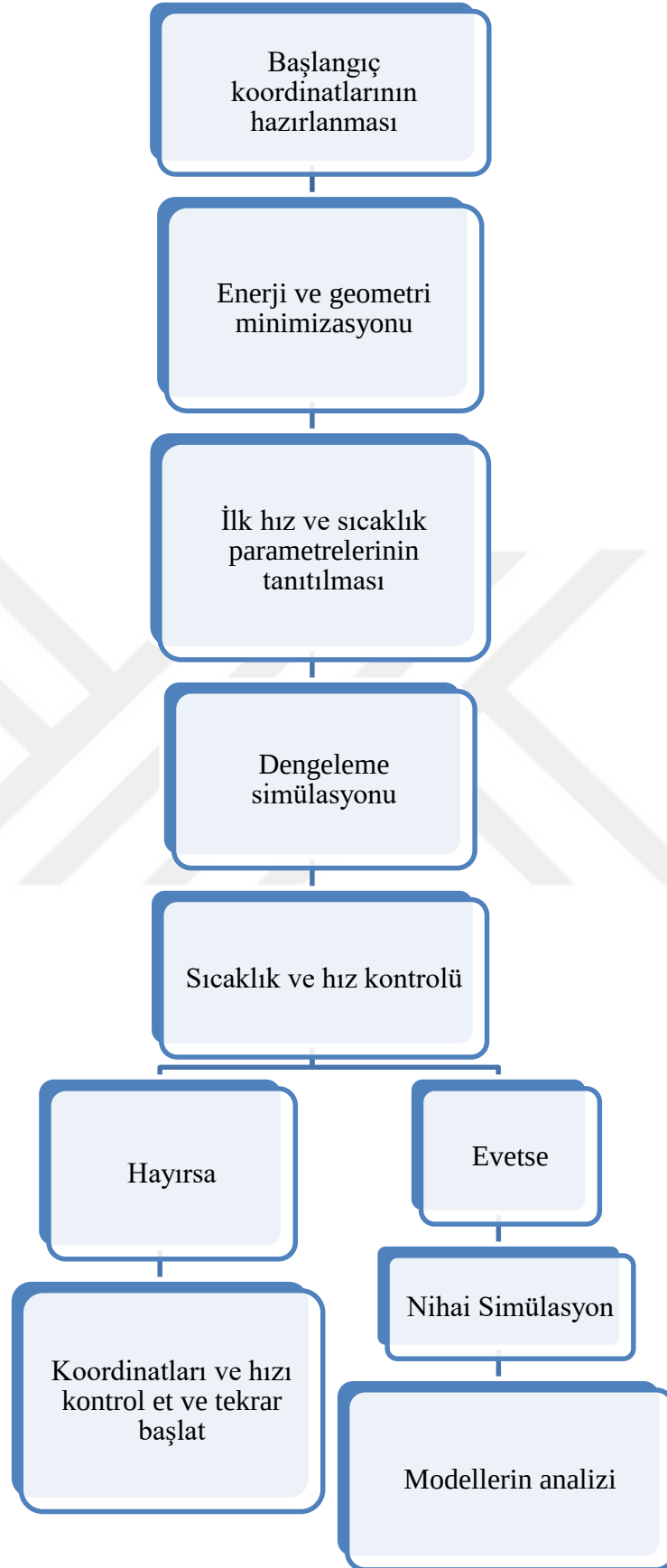
Şekil 2.12 : MD simülasyonunun hazırlık, ilerleme ve sonuçlandırma aşamaları.
