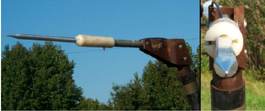
Şekil 4.4. Patlama basınç sensörü oryantasyonu
