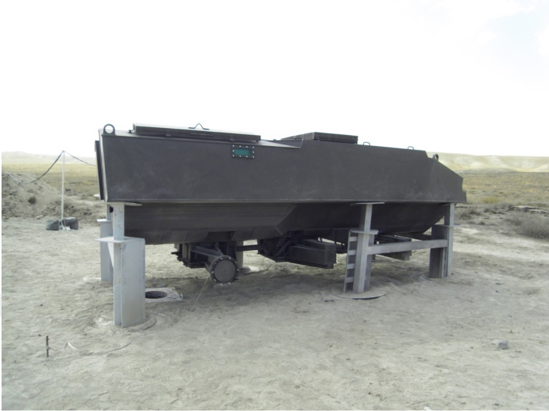
Şekil 4.9. Mayın patlaması için 1/1 ölçek hazırlanmış araç test düzeneği
