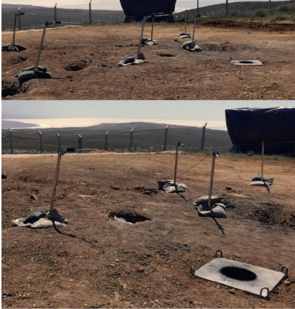
Şekil 4.5. Patlama basıncı sensör yerleşimi
