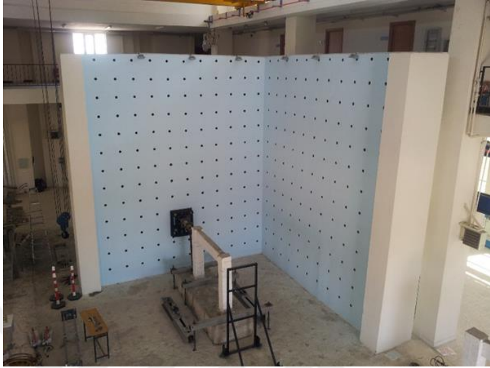
Şekil 2.1. Deprem Araştırma Laboratuvarı Yükleme Duvarı ve Rijit Döşemesi
