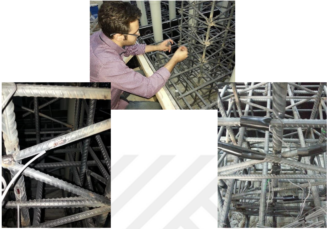
Şekil 2.15. Donatıya Strain-Gage Uygulaması
