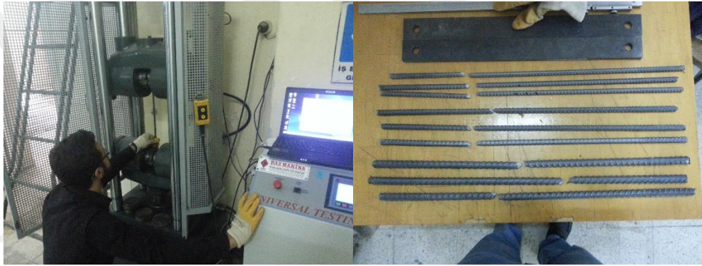
Şekil 2.13. Donatı Çekme Deneyi pres ve numuneleri
