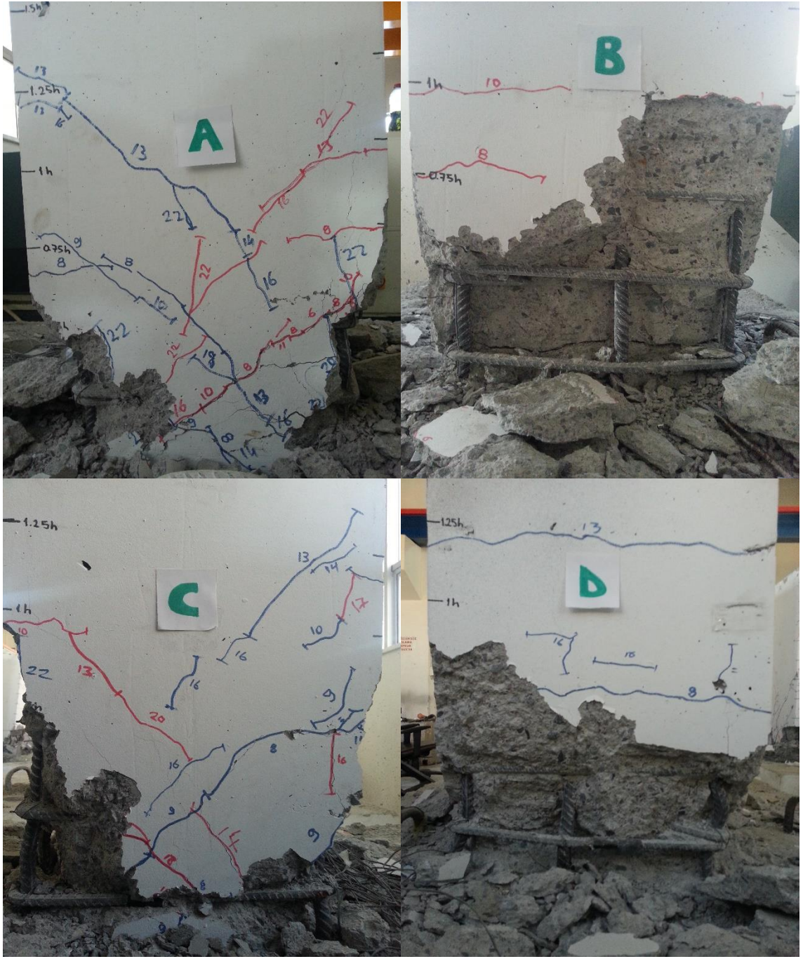
Şekil 3.14. SC800 Ref Ø12 Numunesinin Deney Sonu Fotoğrafları
