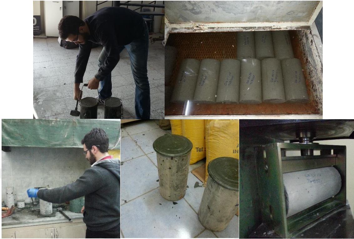
Şekil 2.12. Numunelerin Alınması, Kürlenmesi, Kükürt Başlık Yapımı ve Kırılması İşlemleri
