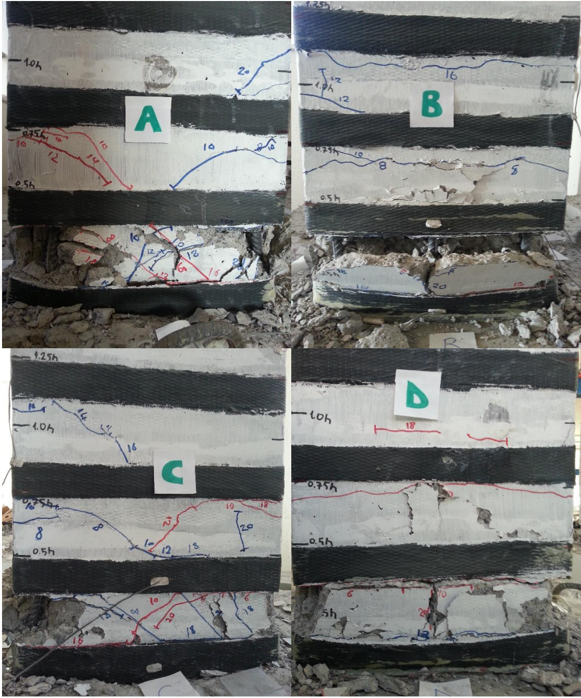
Şekil 3.16. SC800 CFRP 100 Numunesinin Deney Sonu Fotoğrafları
