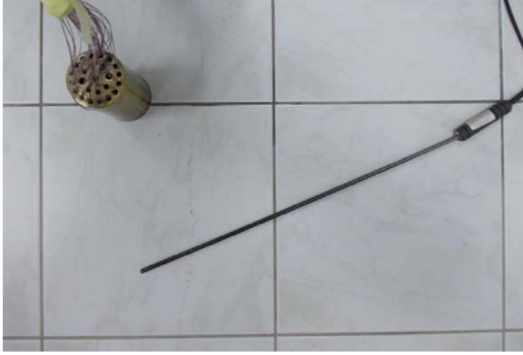
Şekil B.3 : Termoelemanlar ve referans termometresi.
