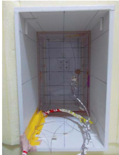
Şekil A.5 : Birinci ve ikinci deney paketlerinde kavite iç duvarları.
