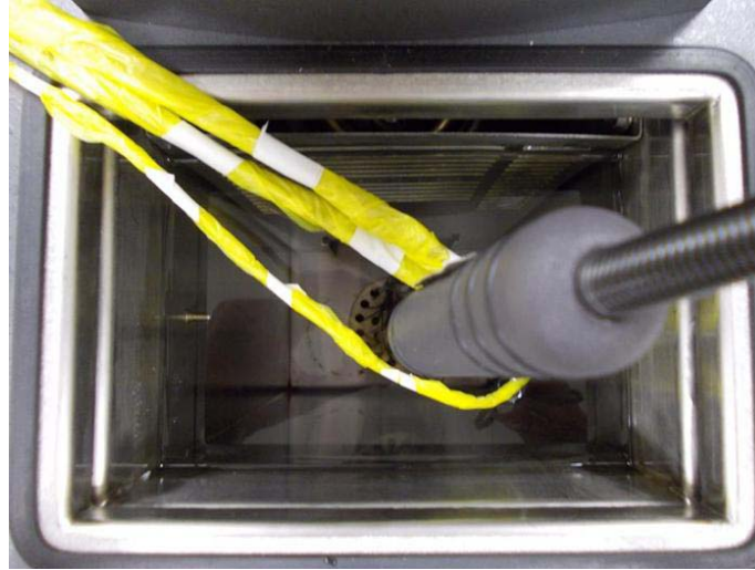
Şekil B.2 : Sabit sıcaklık banyosuna üstten bakış.
