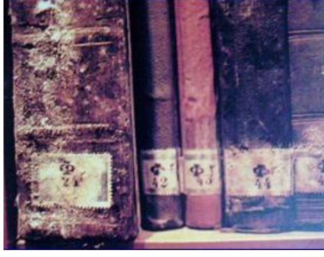
Şekil 3. Mantarın cilt üzerindeki tahribatı.
