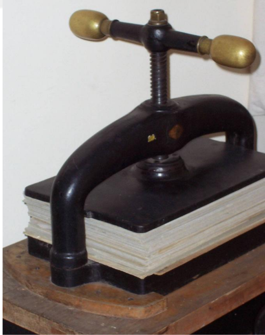
Şekil 13. Prese alınmış onarılan sayfalar.
