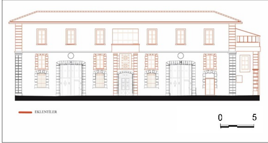
Şekil 45. Kılavuz Kaptanlar Köşkü Eklentilerinin Cephe Görünüşünde Gösterimi
