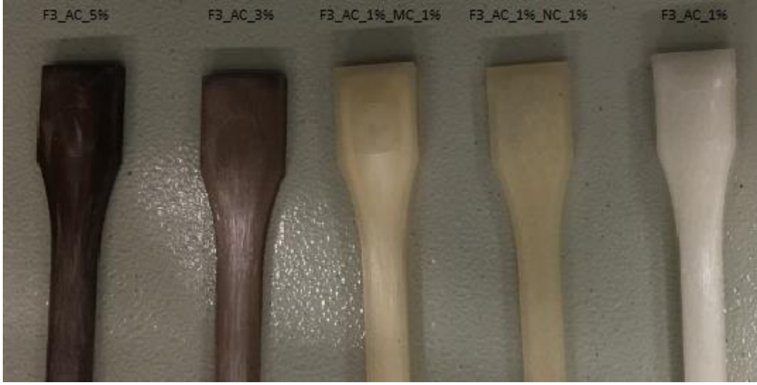
Şekil 4. 6 AC oranına bağlı numunelerdeki renk değişimi
