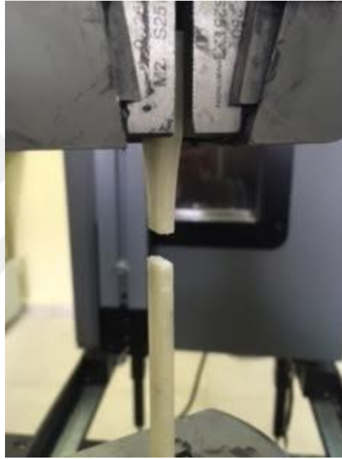
řekil 3. 1 ekme testi uygulaması
