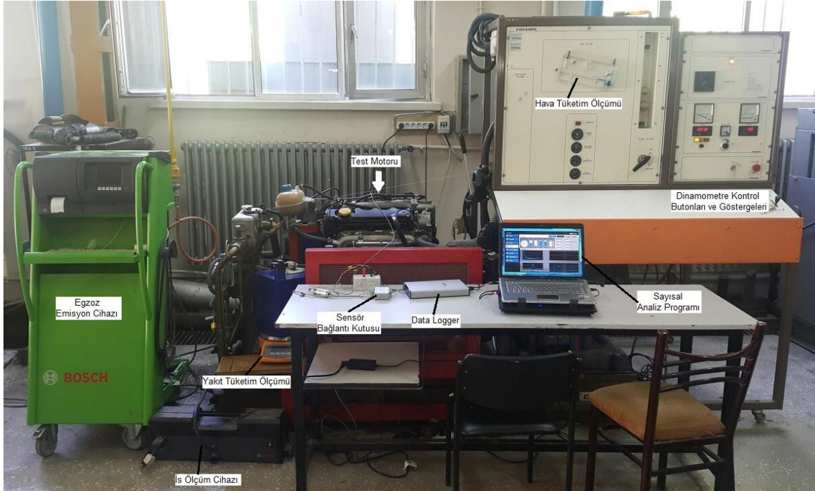
Şekil 2.2. Deney düzeneğinin genel görünümü
