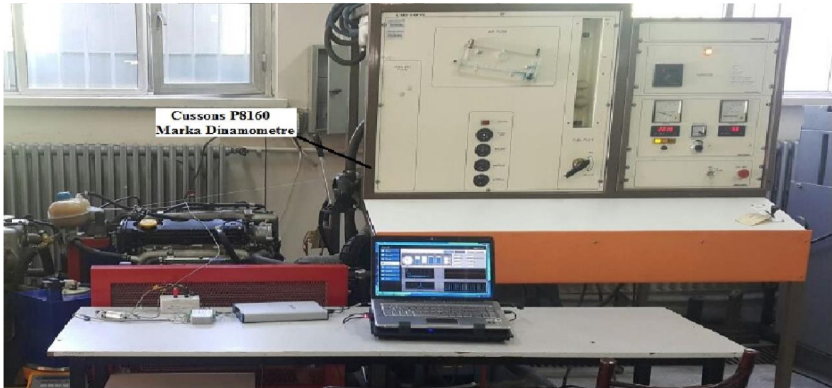
Şekil 2.3. Cussons P8160 marka dinamometrenin genel görünümü
