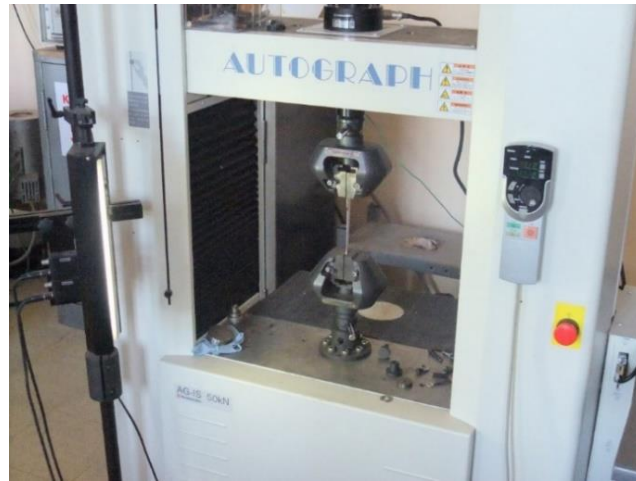
Şekil 5. 11 Shimadzu çekme deneyi cihazı
