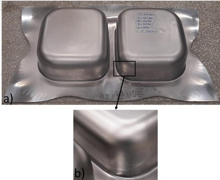
Şekil 6. 3 a) Köprü bölgesini kontrol eden 1 ve 2 nolu pistonlardaki pot basınçlarının artırılması ile gerçekleştirilen deney sonucu elde edilen parça, b) Yan duvar
