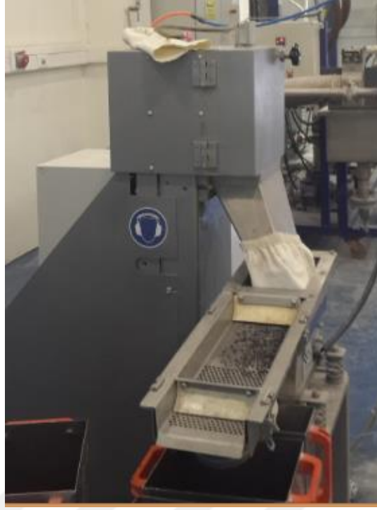
Şekil 5.20. Peletleyici ve 3mm uzunluğunda peletler
