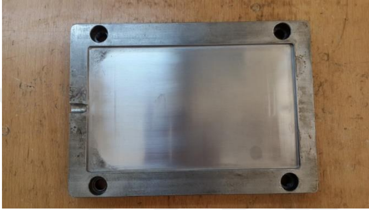
řekil 5.22. Enjeksiyon kalıplamada kullanılan 3 mm kalınlıęında kalıp
