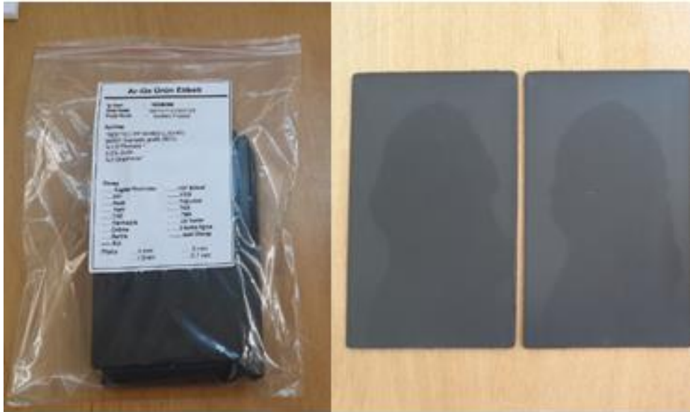
řekil 5.23. Enjeksiyon kalıplama ile elde edilen test numuneleri
