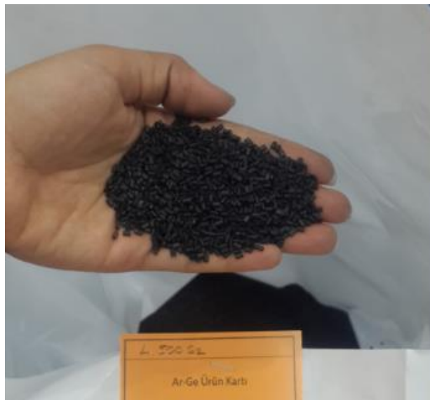
Şekil 5.21. Üretilen polipropilen esaslı kompozit peletler
