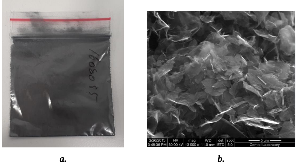
Şekil 5.3. a) iGP2 grafen nano pullar b) SEM görüntüsü
