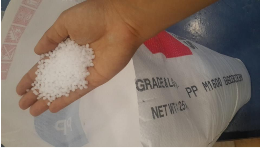
Şekil 5.1. LG Seetec M1600 polipropilen malzeme
