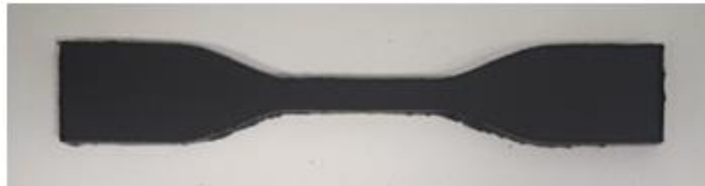
Şekil 6.16. Polimerik kompozit çekme numunesi örneği
