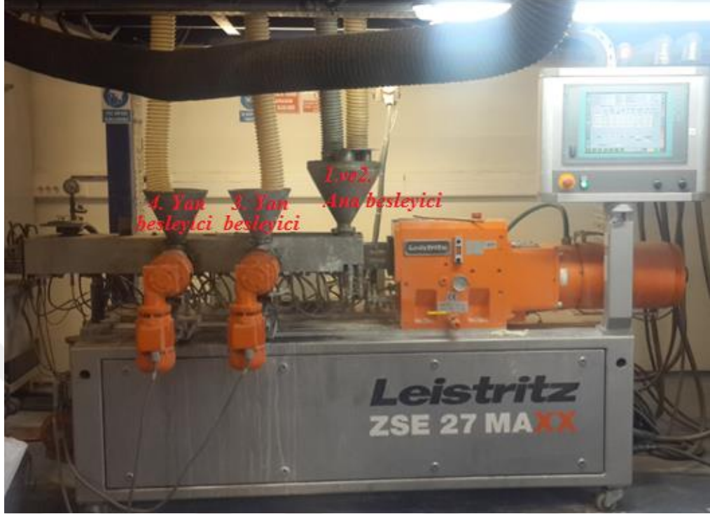
Şekil 5.18. Ekstrüzyon makinesi besleyicileri
