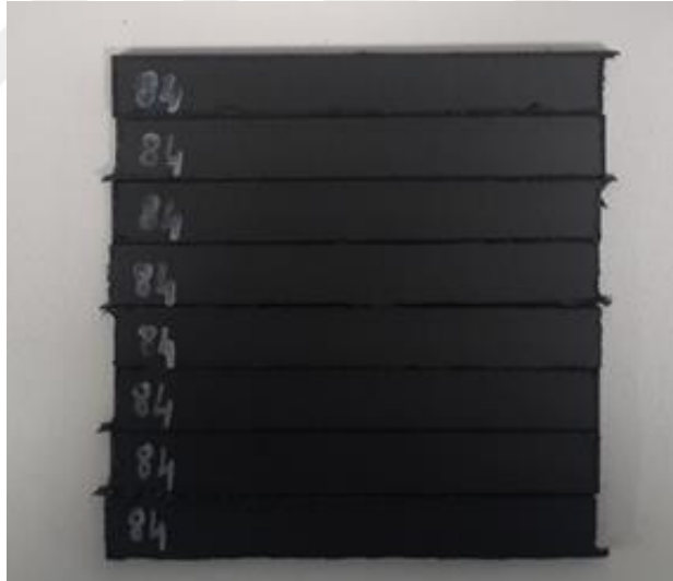
Şekil 6.18. 3 nokta eğilme testi numuneleri
